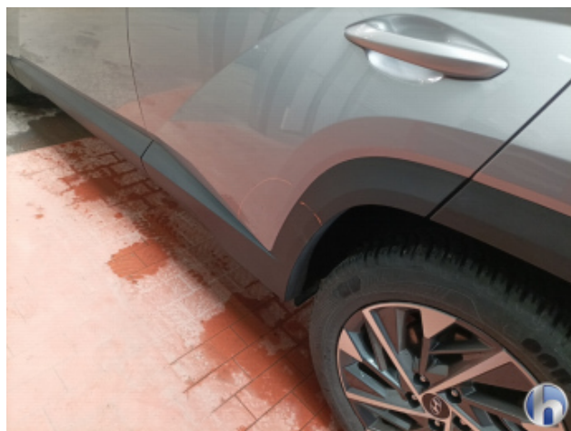
6. Tür Hinten - Links Beschädigt - Instandsetzen und Lackieren
