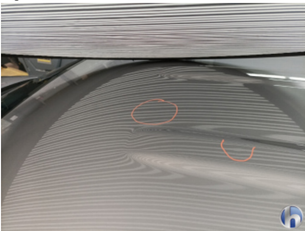
1. Dach Hagelschaden - Sanft Instandsetzen
