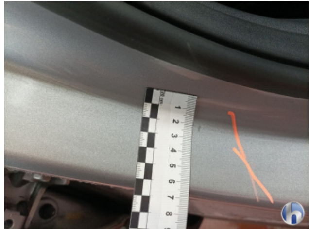
8. Türeinstieg Vorne - Rechts Kratzer - Smart Repair
