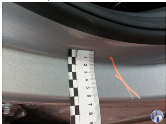
8. Türeinstieg Vorne - Rechts Kratzer - Smart Repair
