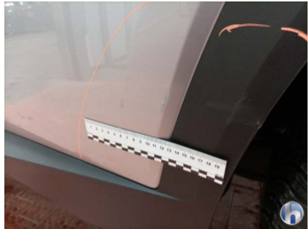
6. Tür Hinten - Links Beschädigt - Instandsetzen und Lackieren
