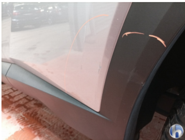
6. Tür Hinten - Links Beschädigt - Instandsetzen und Lackieren
