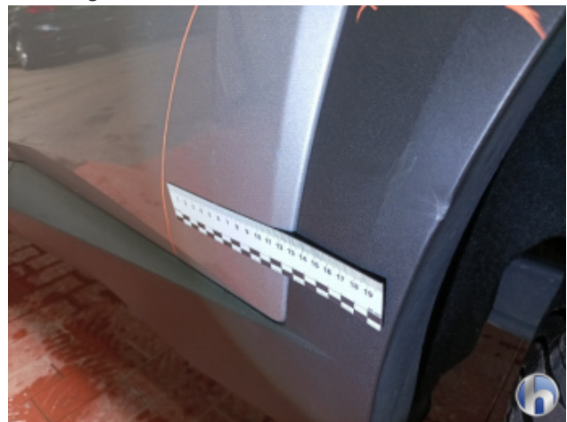
6. Tür Hinten - Links Beschädigt - Instandsetzen und Lackieren
