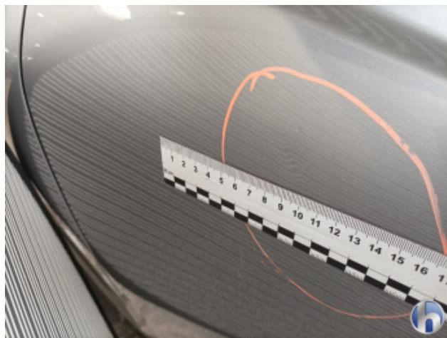
4. Tür Vorne - Links Delle - Sanft Instandsetzen
