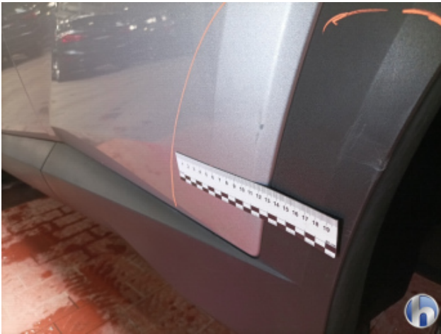
6. Tür Hinten - Links Beschädigt - Instandsetzen und Lackieren
