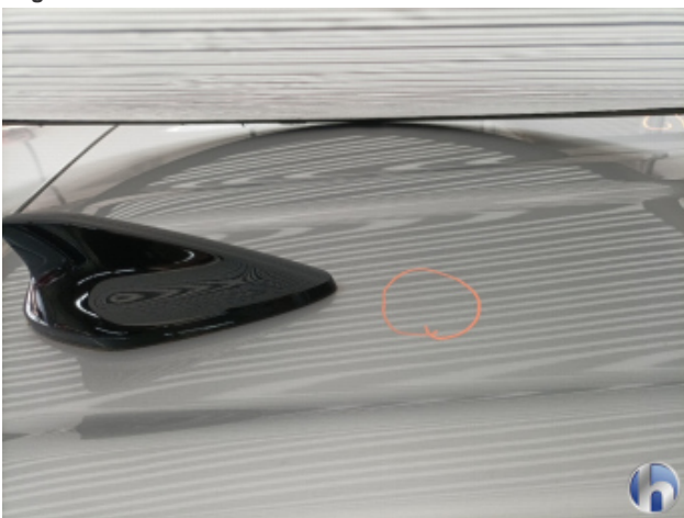
1. Dach Hagelschaden - Sanft Instandsetzen
