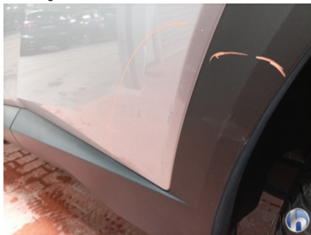
6. Tür Hinten - Links Beschädigt - Instandsetzen und Lackieren
