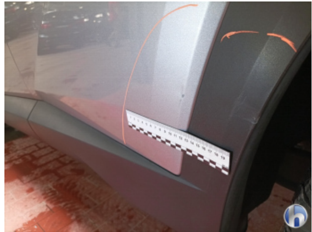
6. Tür Hinten - Links Beschädigt - Instandsetzen und Lackieren
