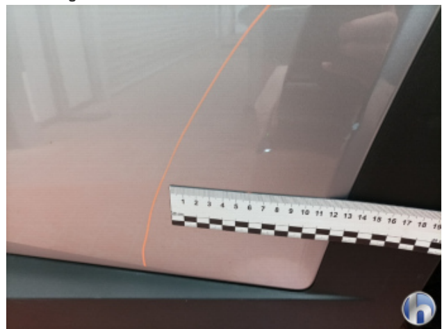
6. Tür Hinten - Links Beschädigt - Instandsetzen und Lackieren
