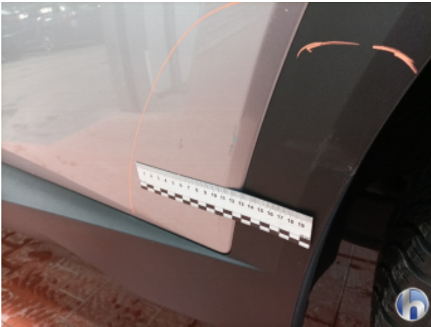
6. Tür Hinten - Links Beschädigt - Instandsetzen und Lackieren
