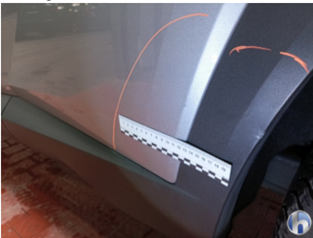
6. Tür Hinten - Links Beschädigt - Instandsetzen und Lackieren
