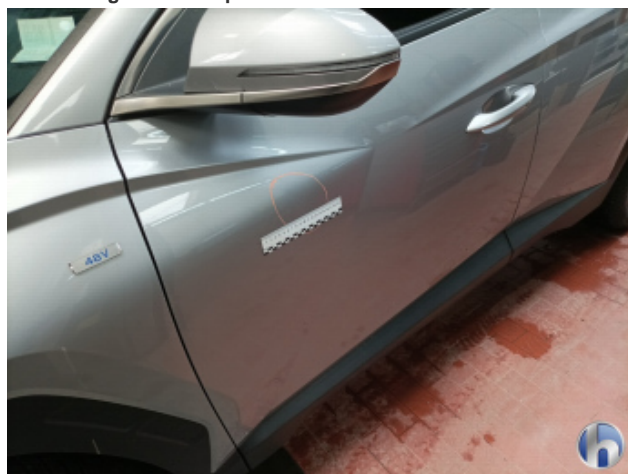
4. Tür Vorne - Links Delle - Sanft Instandsetzen
