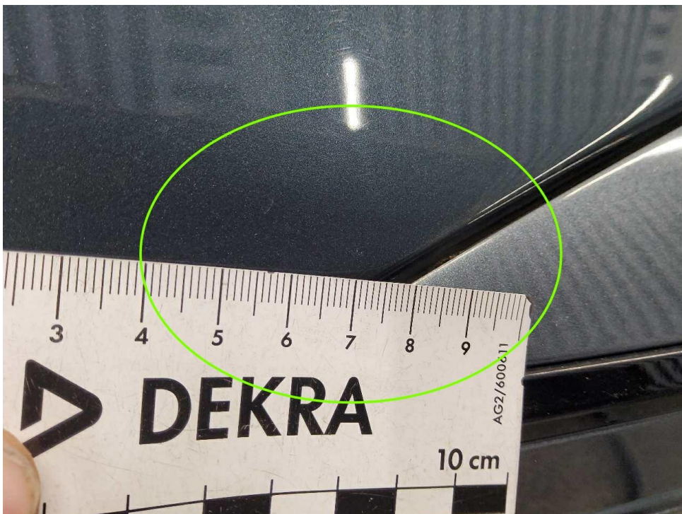
Bild 22 : Mehrere Bauteile, Staubeinschluss
