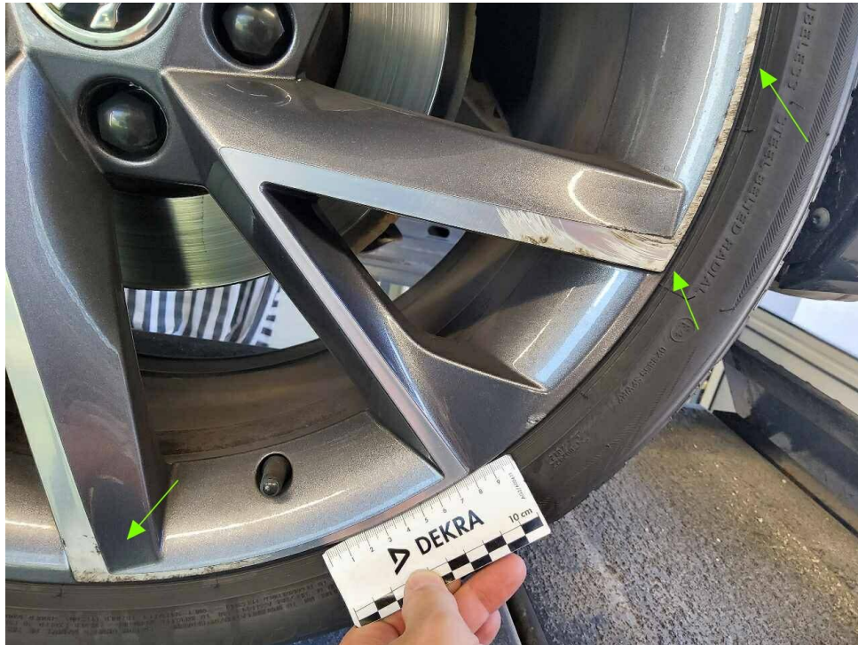
Bild 17 : Felge hinten links (glanzgedreht), verschrammt
