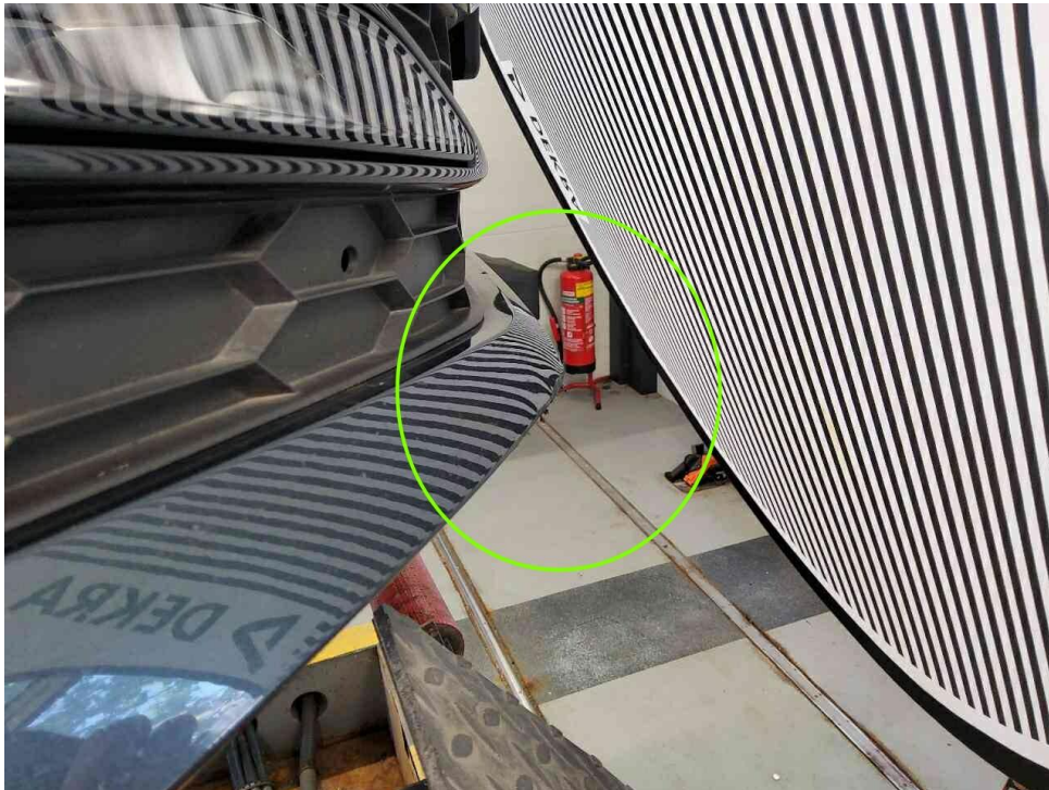
Bild 19 : Stoßfängerabdeckung vorne, verformt
