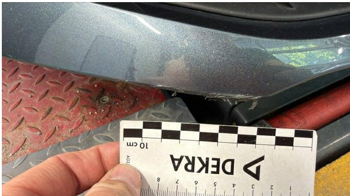
Bild 20 : Stoßfängerabdeckung vorne, verformt
