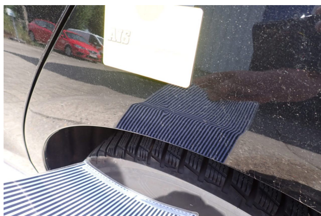
Beschädigung 5: Seitenwand links: Seitenwand - Delle / Lackschaden - Smart Repair
