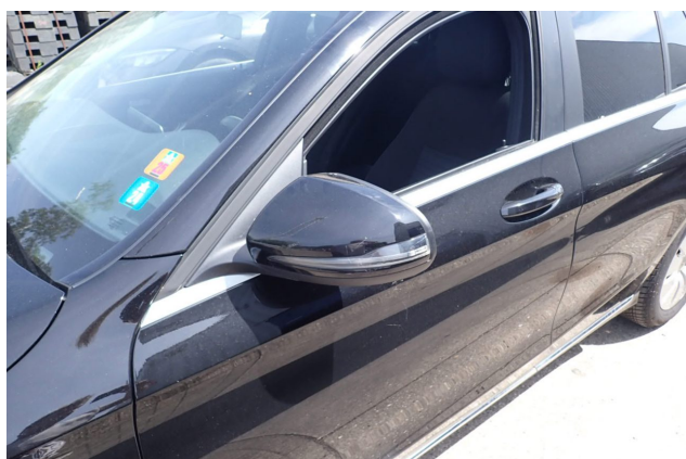
Beschädigung 3: Blinkleuchte: Spiegel links - verkratzt / verschürft - erneuern
