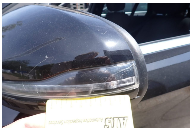
Beschädigung 3: Blinkleuchte: Spiegel links - verkratzt / verschürft - erneuern
