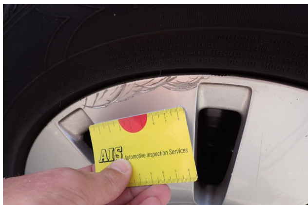
Beschädigung 8: Rad/Reifen: Leichtmetallfelge vorn rechts - verkratzt / verschürft - instandsetzen und lackieren
