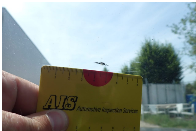
Beschädigung 4: Verglasung: Frontscheibe - Steinschlag - Smart Repair
