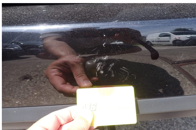
Beschädigung 9: Stossfänger hinten: Stossfänger hinten - verkratzt / verschürft - instandsetzen und lackieren
