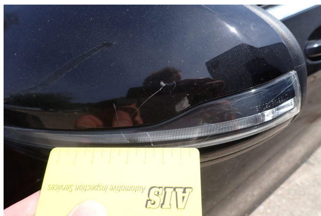
Beschädigung 2: Außenspiegel links: Abdeckkappe - verkratzt / verschürft - lackieren
