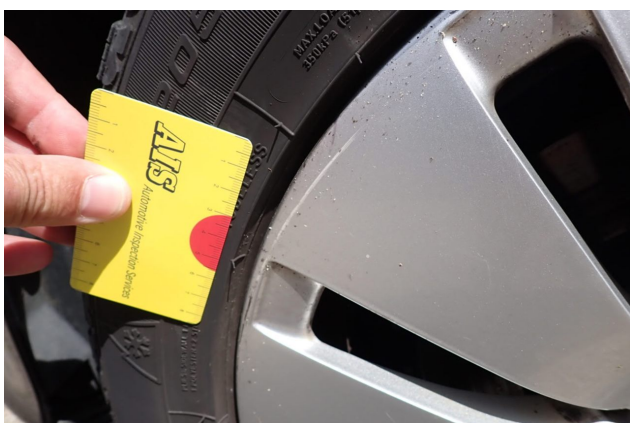
Beschädigung 7: Rad/Reifen: Leichtmetallfelge vorn links - verkratzt / verschürft - instandsetzen und lackieren
