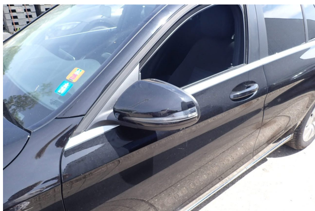
Beschädigung 2: Außenspiegel links: Abdeckkappe - verkratzt / verschürft - lackieren
