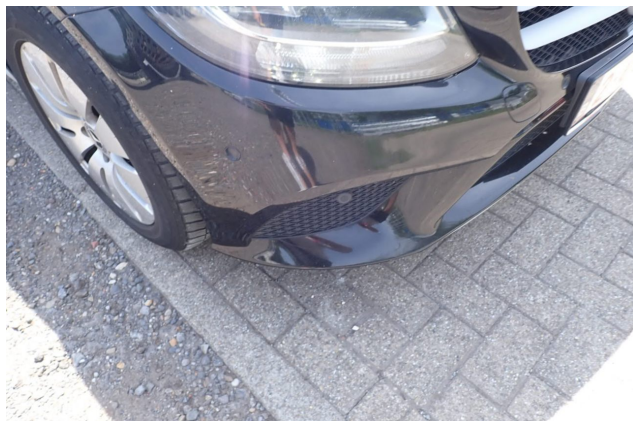
Beschädigung 1: Stossfänger vorn: Stossfänger vorn - verkratzt / verschürft - auslegen / polieren
