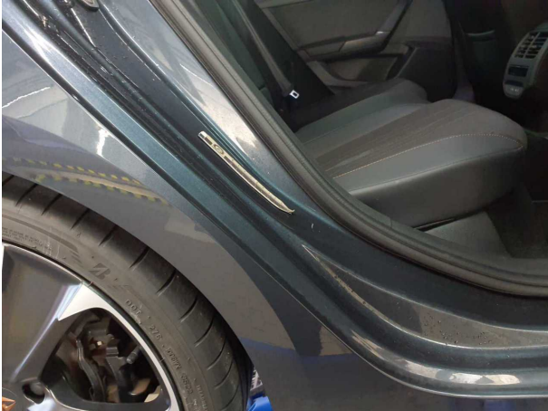
Beschädigung #2: Seitenwand rechts: Kniestück - verkratzt / verschürft - Smart Repair
