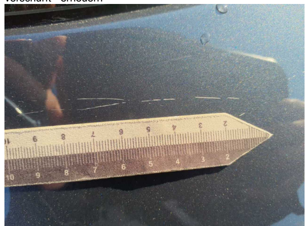
Beschädigung #4: Heckklappe/-tür: Heckklappe (Teilweise) - verkratzt / verschürft - lackieren
