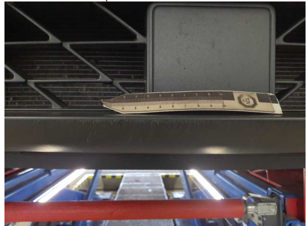
Beschädigung #3: Stossfänger vorn: Spoiler - verkratzt / verschürft - erneuern
