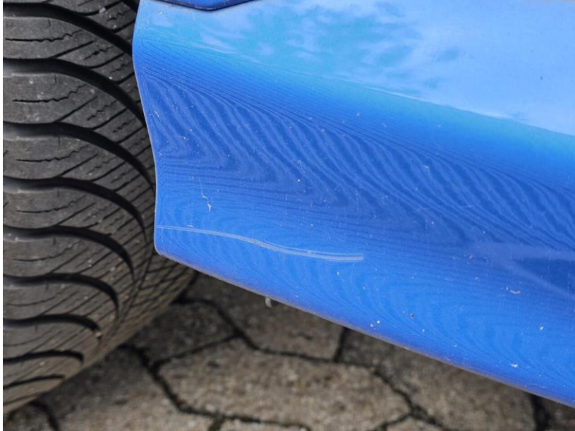
Altschaden Unterholmabdeckung rechts
