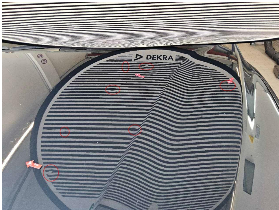
Bild 19 : Motorhaube 9x eingedellt
