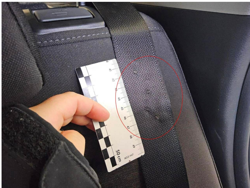
Bild 14 : Sicherheitsgurt hinten links beschädigt
