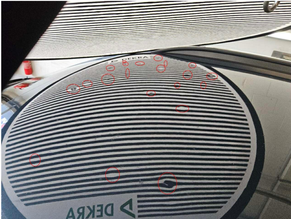
Bild 21 : Dach min. 20x eingedellt
