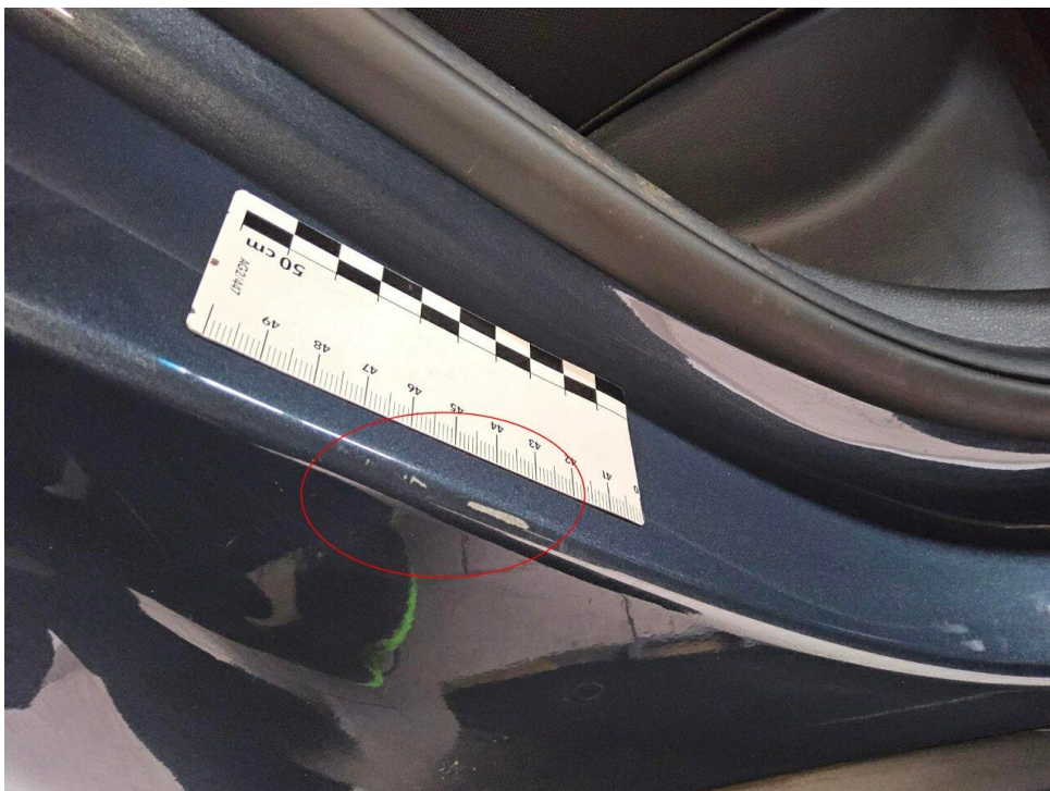
Bild 12 : Einstieg hinten rechts Delle und Kratzer
