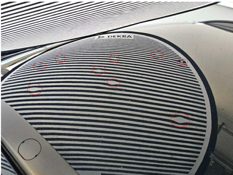
Bild 22 : Dach min. 20x eingedellt
