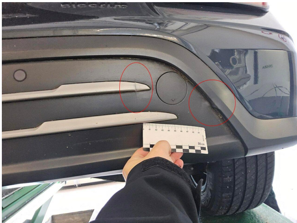
Bild 10 : Stoßfängeransatz hinten deformiert
