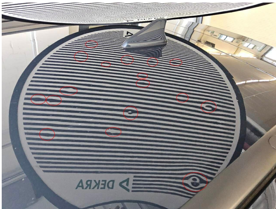
Bild 23 : Dach min. 20x eingedellt
