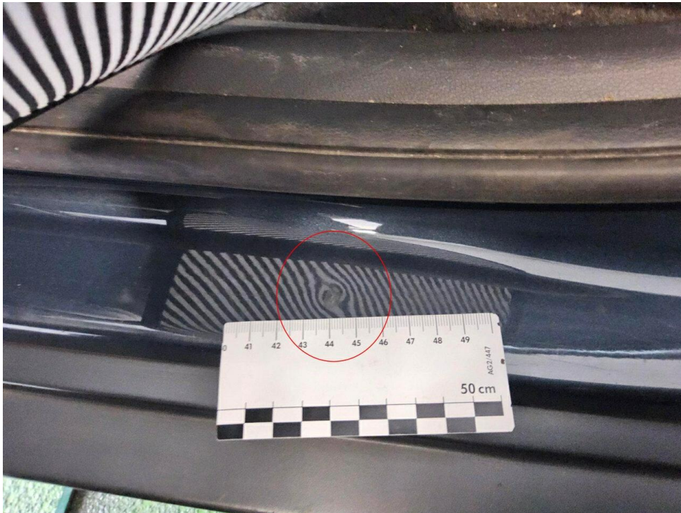
Bild 15 : Einstiegslackierung vorne links Delle und zerkratzt
