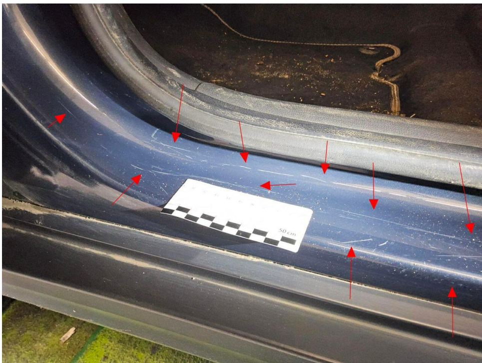
Bild 16 : Einstiegslackierung vorne links Delle und zerkratzt
