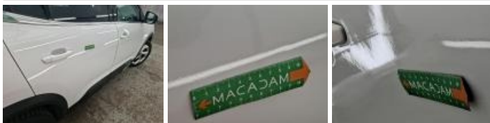
Porte AVD, Mauvaise réparation, Peindre
