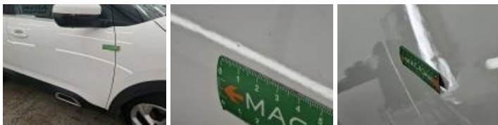
Aile AVD, Mauvaise réparation, Peindre
