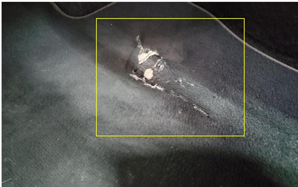
Bild 19 : Fahrerfußraum Fußmatte beschädigt
