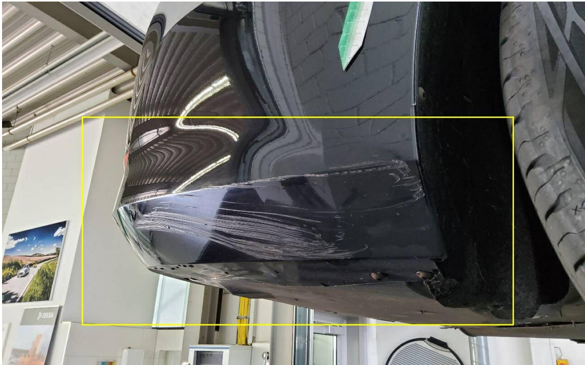
Bild 43 : Stoßfängerverkleidung hinten verschrammt und verformt
