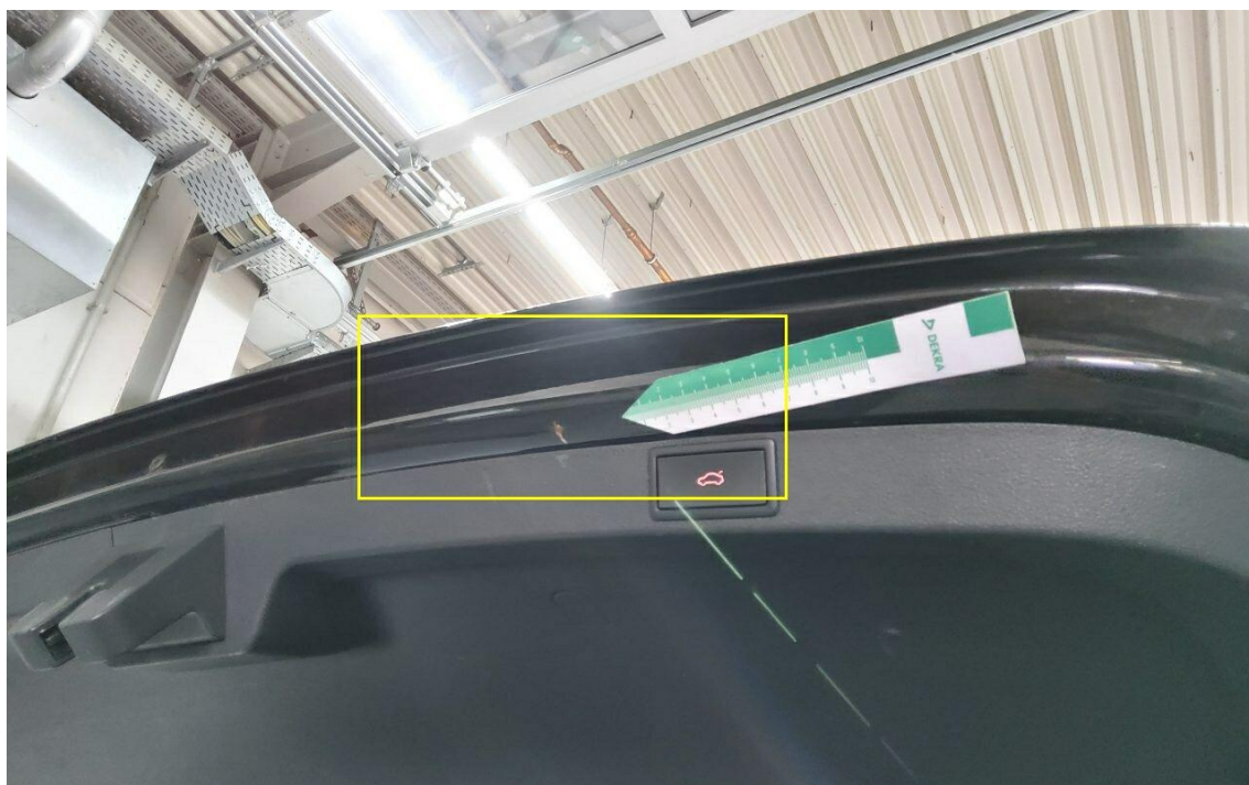
Bild 26 : Heckklappe innen Korossionsbildung
