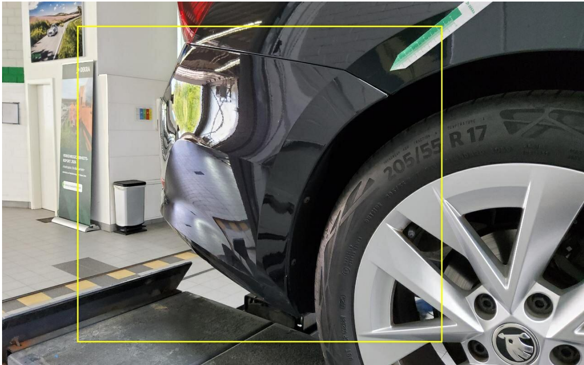
Bild 39 : Stoßfängerverkleidung hinten verschrammt und verformt
