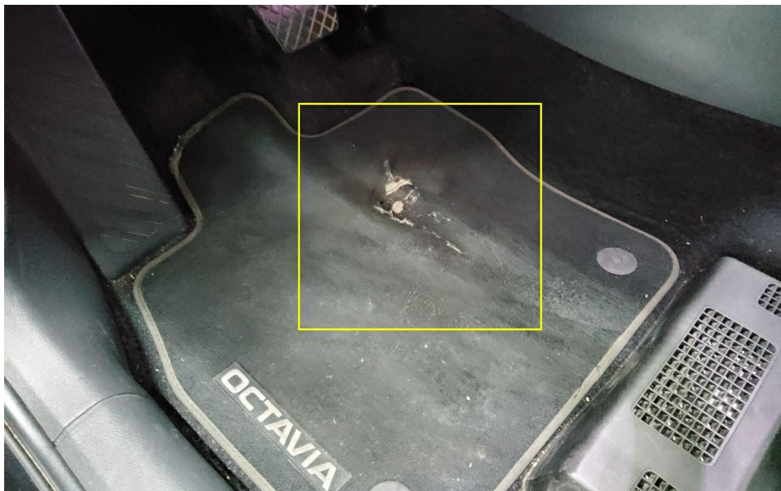
Bild 18 : Fahrerfußraum Fußmatte beschädigt
