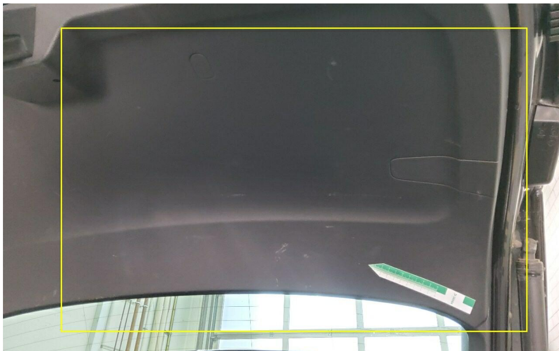
Bild 25 : Heckklappenverkleidung mehrere leichte Kratzer
