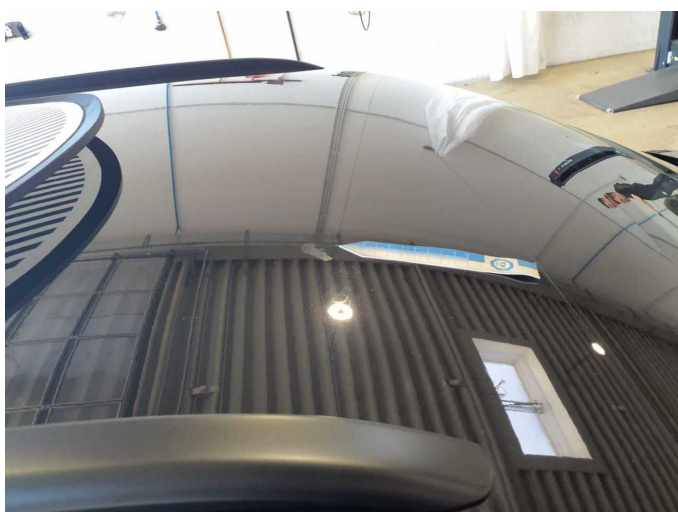
Damage 15: Roof: Roof (Anätzung) - Paint defect - Paint
