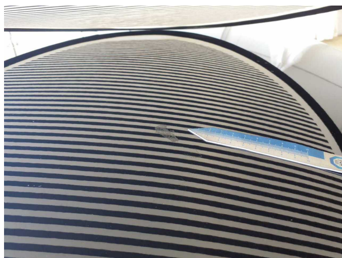
Damage 15: Roof: Roof (Anätzung) - Paint defect - Paint
