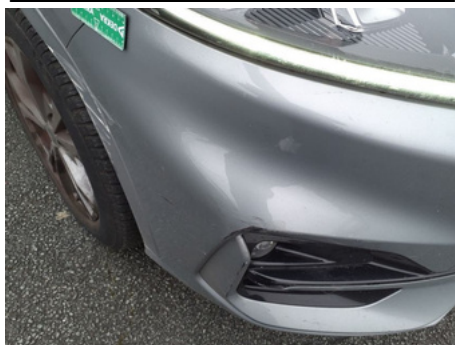
Pare-chocs / Avant / Enfoncement
