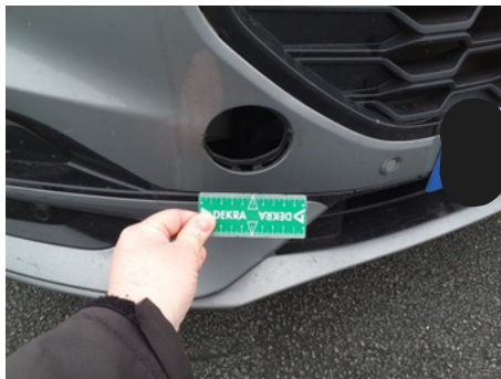
Obtuteur de pare-chocs / Avant / Manquant
