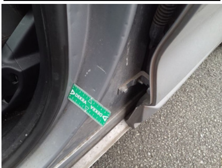
Entrée de porte / Avant Gauche / Enfoncement
