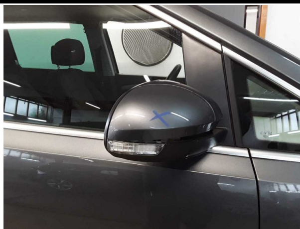
Beschädigung #9: Außenspiegel rechts: Spiegelgehäuse - beschädigt - erneuern
