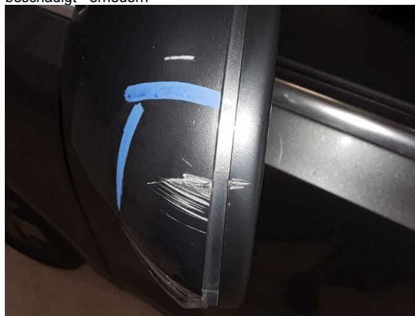
Beschädigung #10: Außenspiegel links: Abdeckkappe - beschädigt - erneuern
