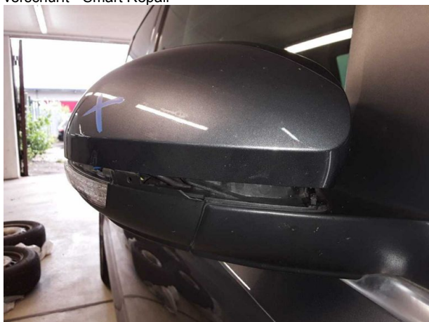
Beschädigung #9: Außenspiegel rechts: Spiegelgehäuse - beschädigt - erneuern
