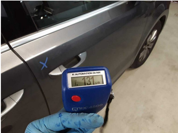
Nachlackierung 1: Schweller links, Seitenwand rechts, Tür hinten links, Tür hinten rechts, Tür vorne links, Tür vorne rechts
