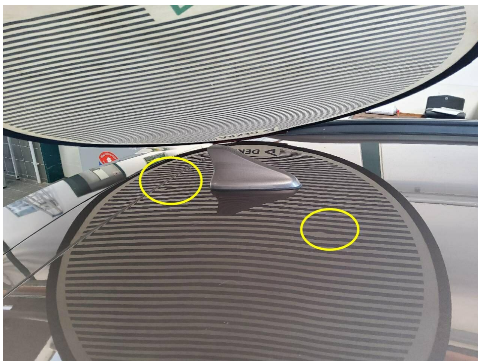
Bild 8 : Dach mehrfach eingedellt
