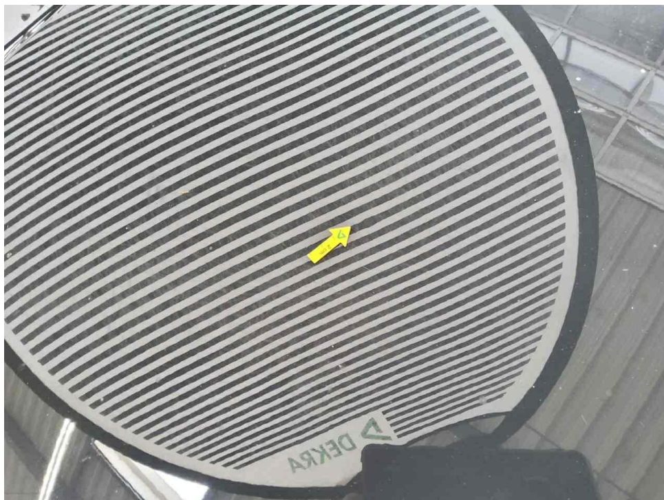
Bild 18 : Motorhaube, eingedellt, drücken
