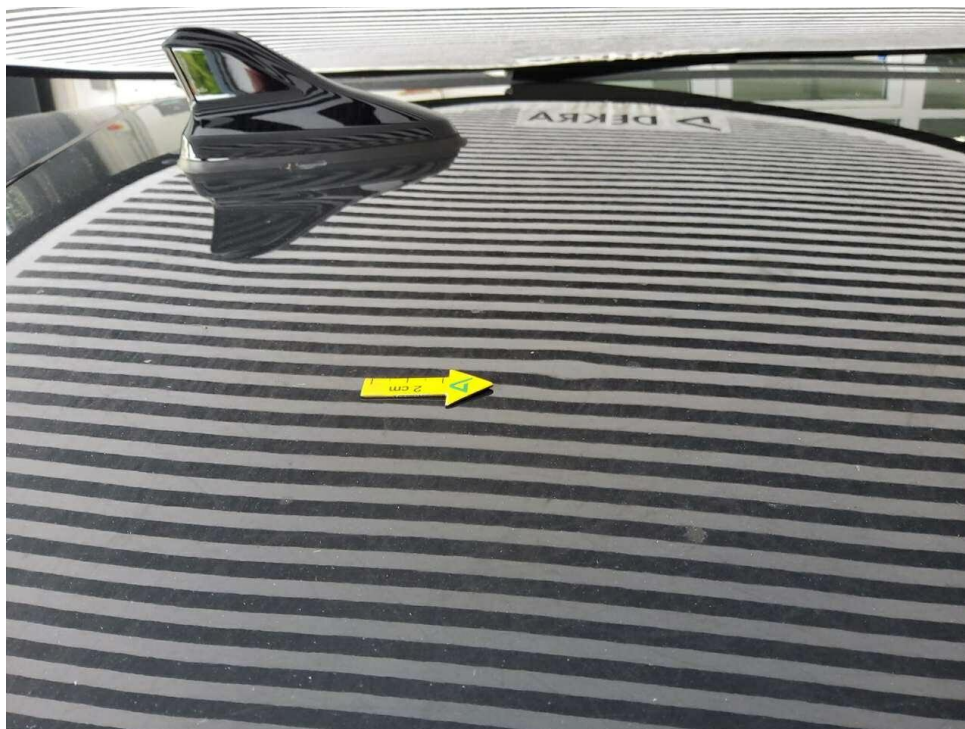
Bild 17 : Dach, eingedellt, drücken
