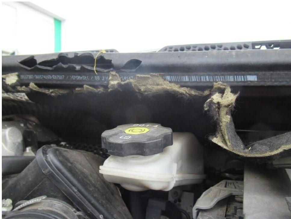
Bild 21 : Motorraum: Dämm/Schallschutz Stirnwand Wasserkasten und Motorhaube,..... beschädigt (Nager)
