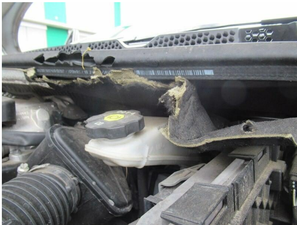
Bild 23 : Motorraum: Dämm/Schallschutz Stirnwand Wasserkasten und Motorhaube,..... beschädigt (Nager)
