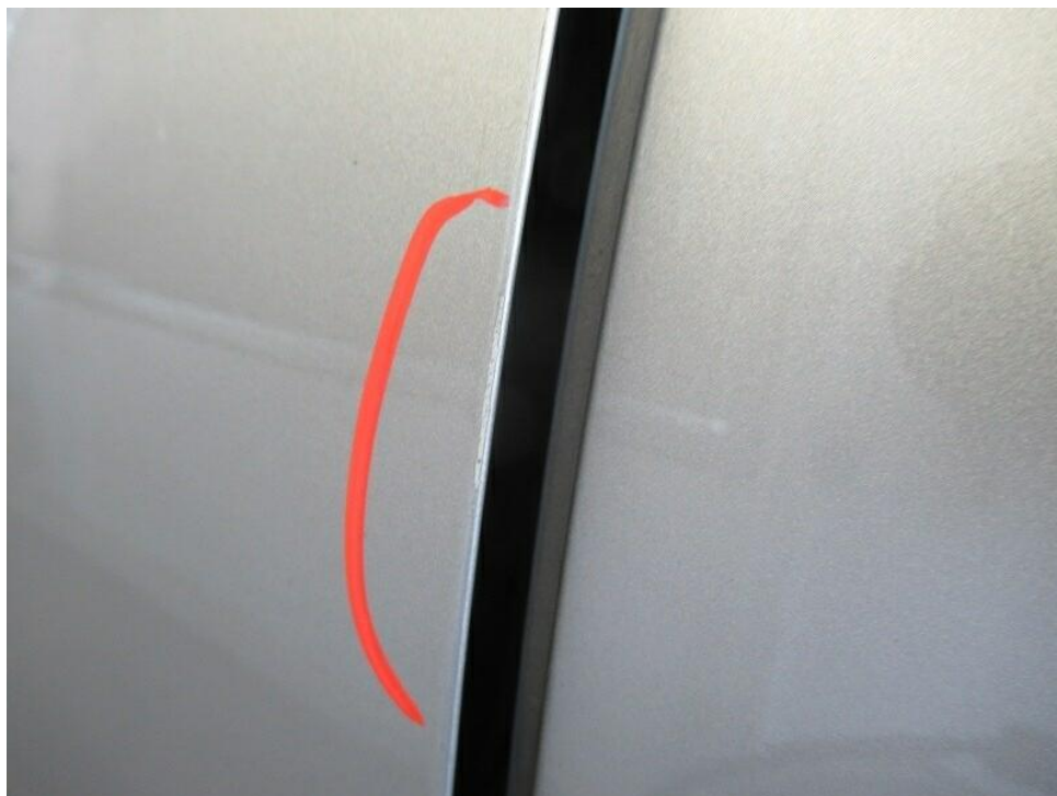
Bild 30 : Tür vorne links Lackierung, zerkratzt, Gebrauchsspur
