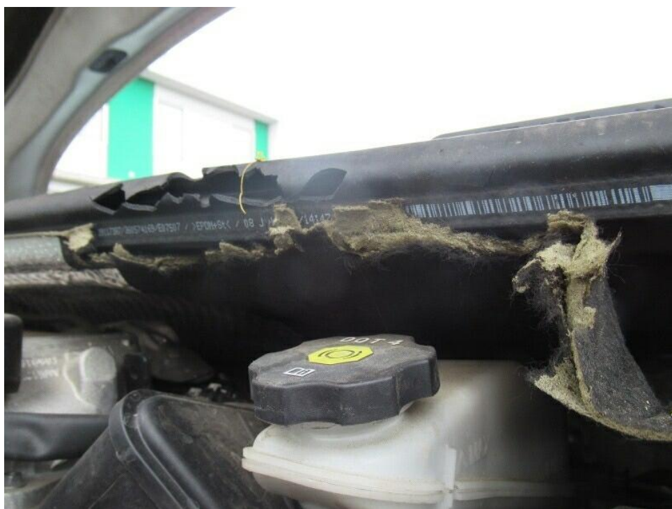
Bild 24 : Motorraum: Dämm/Schallschutz Stirnwand Wasserkasten und Motorhaube,..... beschädigt (Nager)
