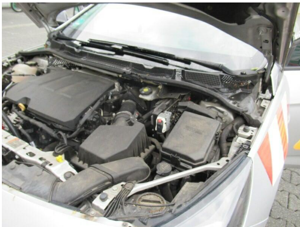
Bild 20 : Motorraum: Dämm/Schallschutz Stirnwand Wasserkasten und Motorhaube,..... beschädigt (Nager)
