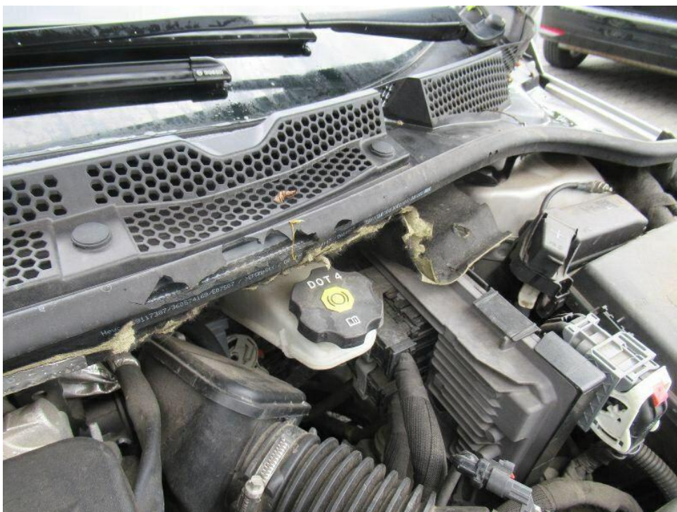
Bild 26 : Motorraum: Dämm/Schallschutz Stirnwand Wasserkasten und Motorhaube,..... beschädigt (Nager)
