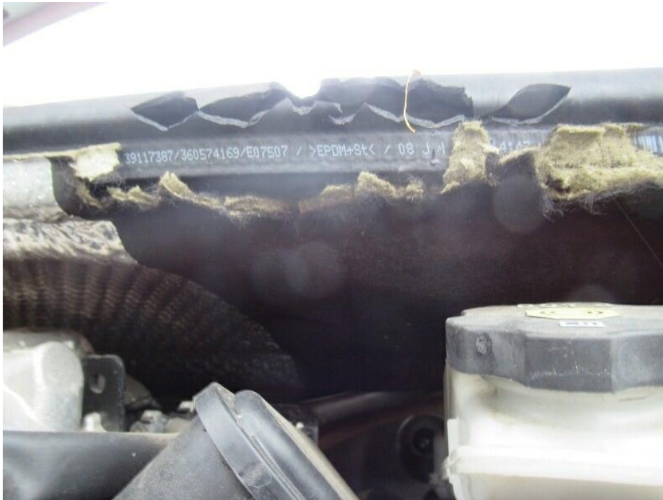
Bild 25 : Motorraum: Dämm/Schallschutz Stirnwand Wasserkasten und Motorhaube,..... beschädigt (Nager)
