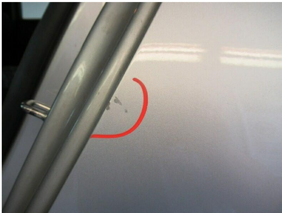
Bild 29 : Seitenteil hinten links Lackierung, zerkratzt, smart repair
