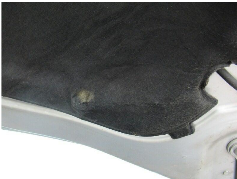
Bild 27 : Motorraum: Dämm/Schallschutz Stirnwand Wasserkasten und Motorhaube,..... beschädigt (Nager)
