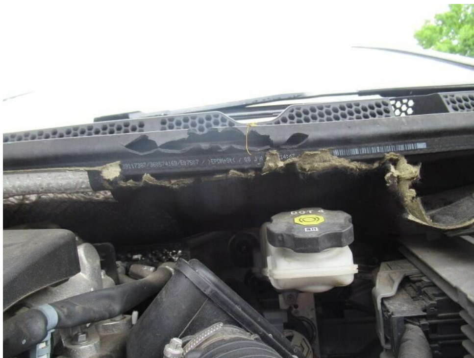
Bild 22 : Motorraum: Dämm/Schallschutz Stirnwand Wasserkasten und Motorhaube,..... beschädigt (Nager)
