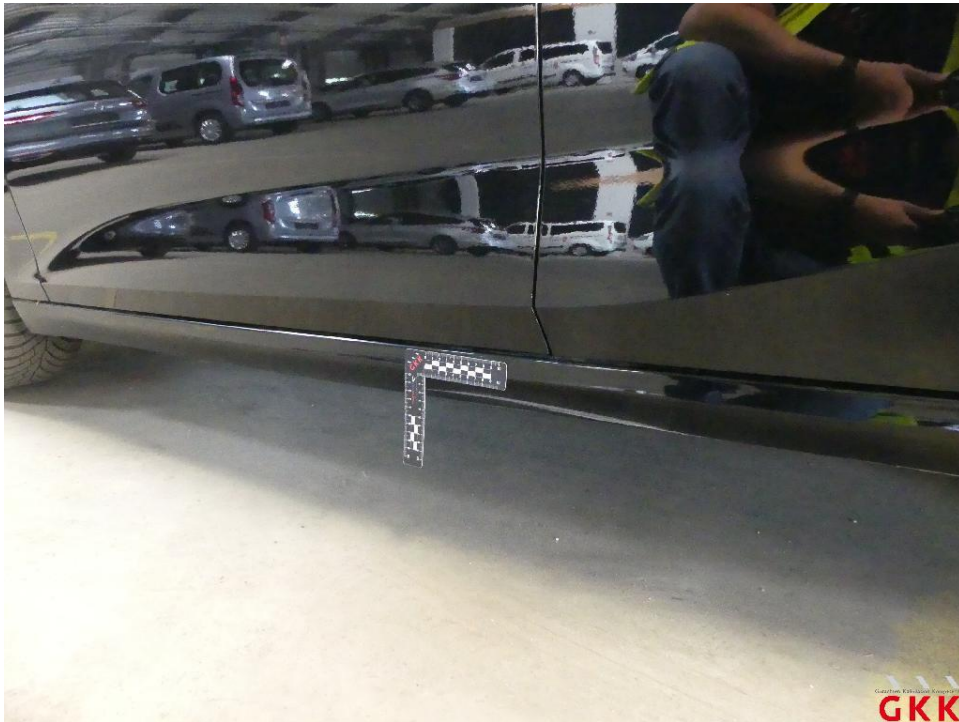
Bild 15 Schweller links, beschädigt, instand setzen - lackieren
