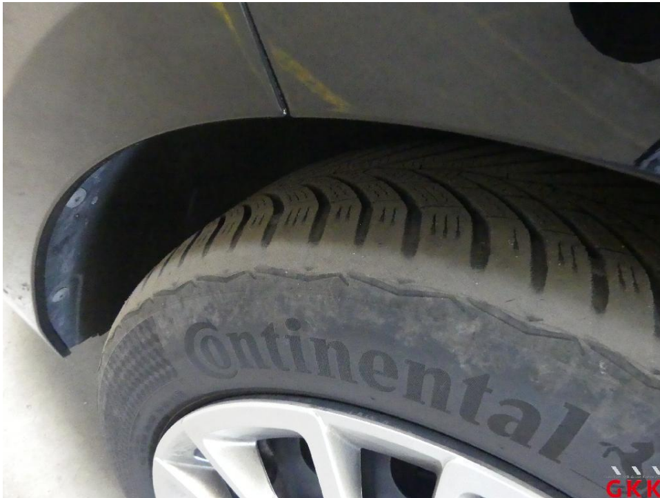
Bild 19 Reifen, vorn links und rechts, Untermaß, ersetzen
