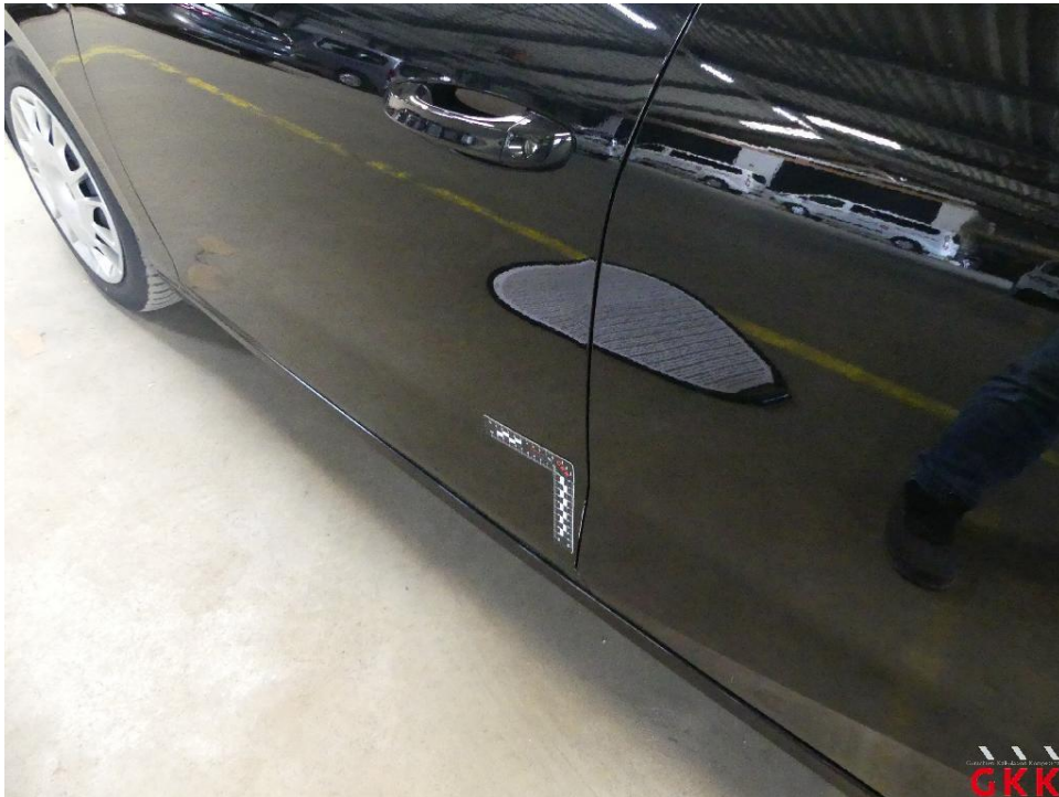
Bild 27 Tür vorne links, Kante, verkratzt, auslegen, schleifen, polieren
