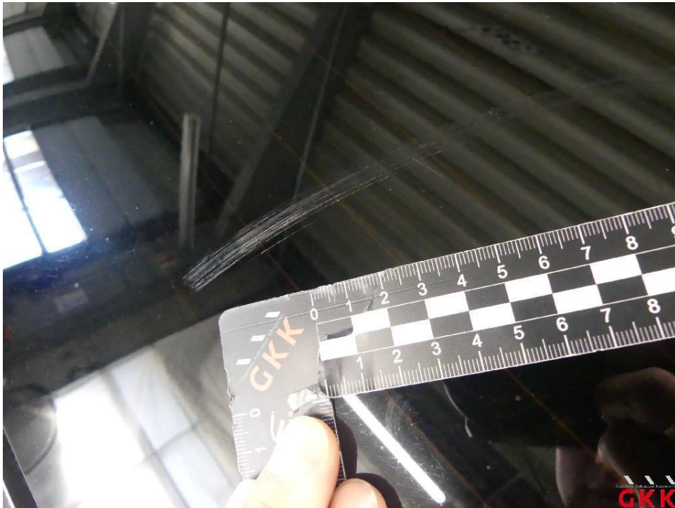
Bild 23 Heckscheibe, getönt, verkratzt, ersetzen
