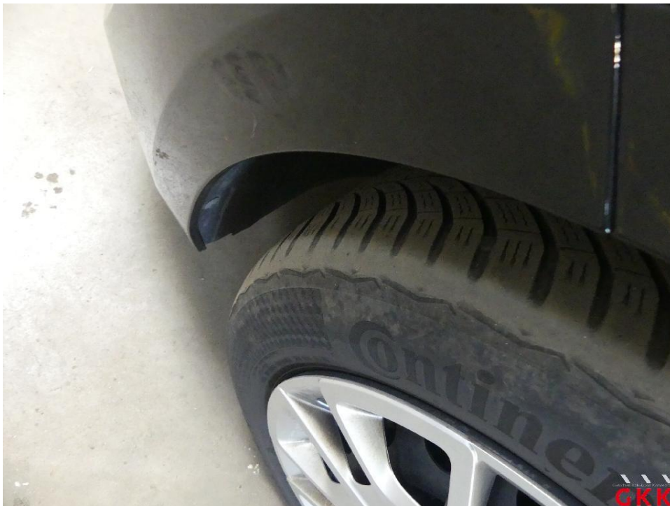
Bild 20 Reifen, vorn links und rechts, Untermaß, ersetzen
