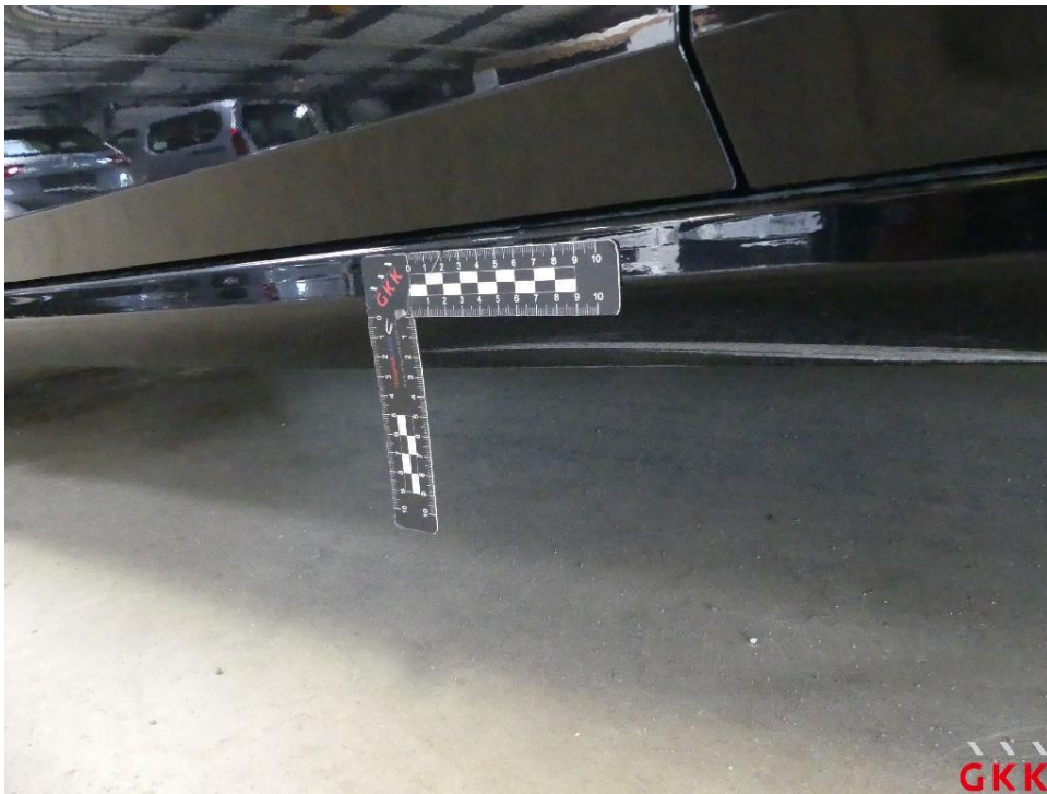
Bild 16 Schweller links, beschädigt, instand setzen - lackieren
