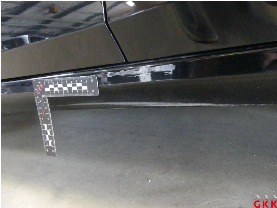
Bild 17 Schweller links, beschädigt, instand setzen - lackieren
