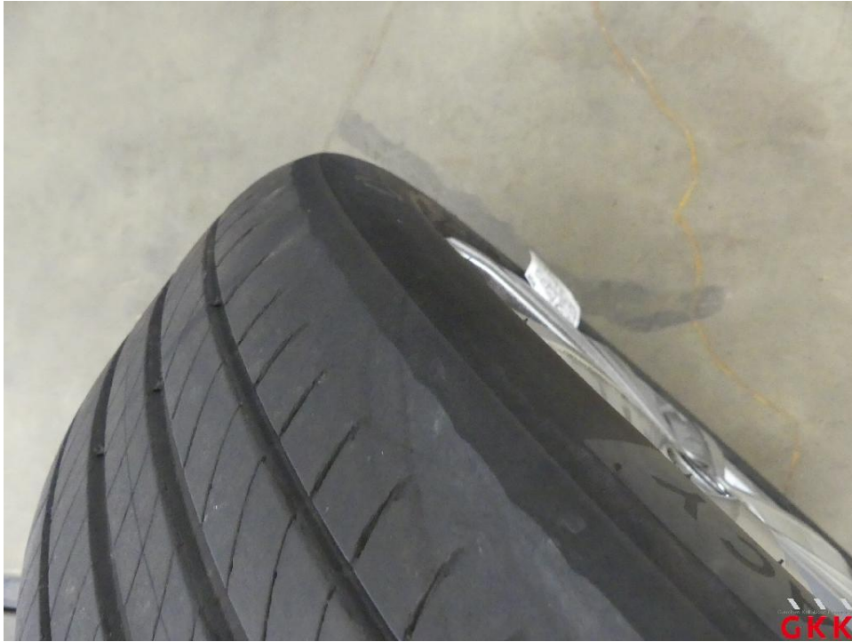
Bild 31 Reifen, 2 x beiliegend, einseitig abgefahren, ersetzen
