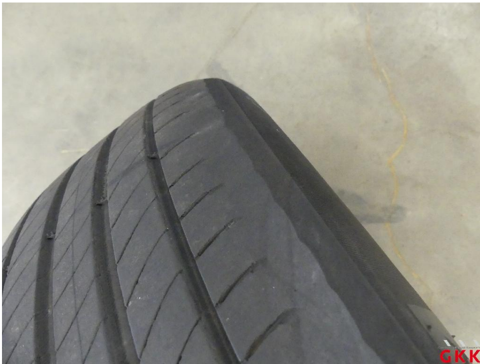
Bild 32 Reifen, 2 x beiliegend, einseitig abgefahren, ersetzen
