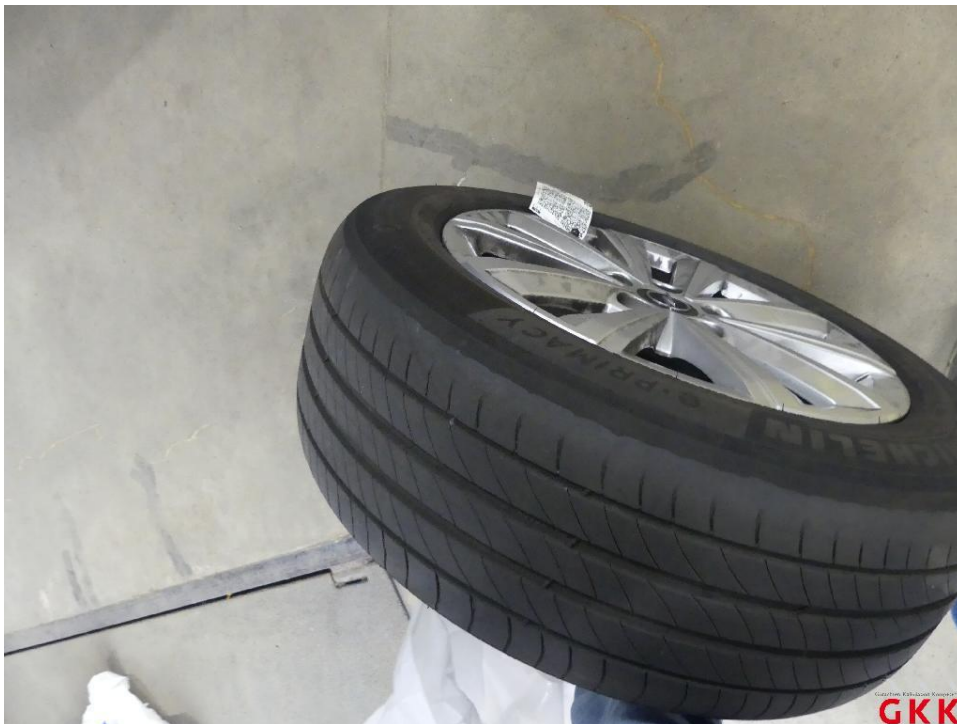
Bild 30 Reifen, 2 x beiliegend, einseitig abgefahren, ersetzen
