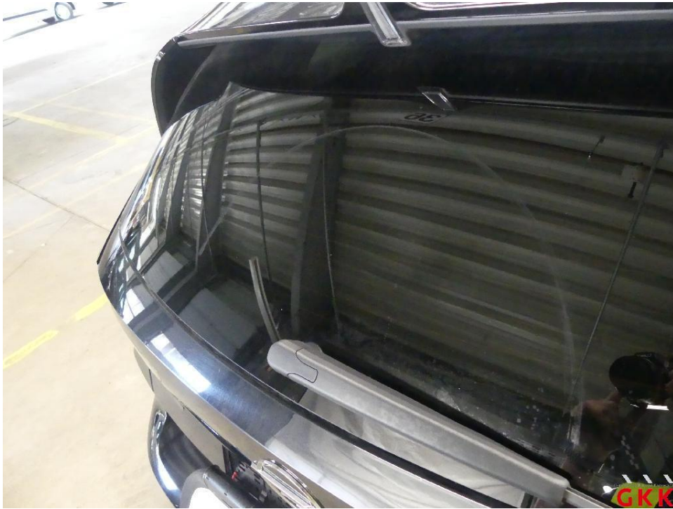
Bild 21 Heckscheibe, getönt, verkratzt, ersetzen
