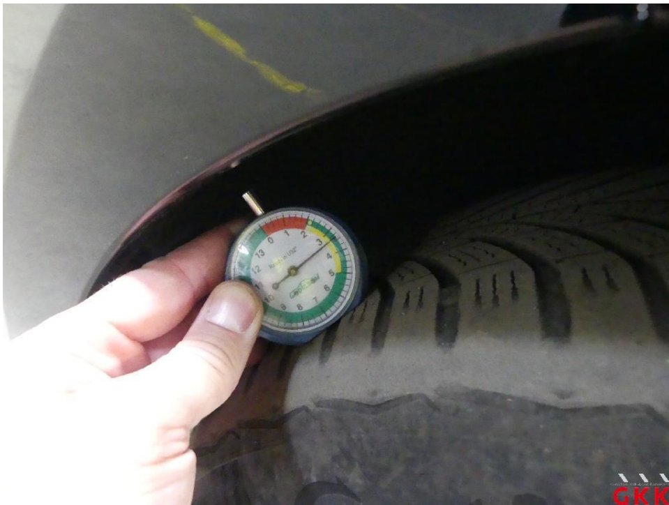
Bild 18 Reifen, vorn links und rechts, Untermaß, ersetzen
