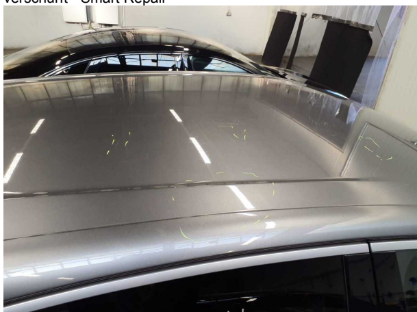
Beschädigung #2: Fahrzeugdach: Dach - verkratzt / verschürft - lackieren
