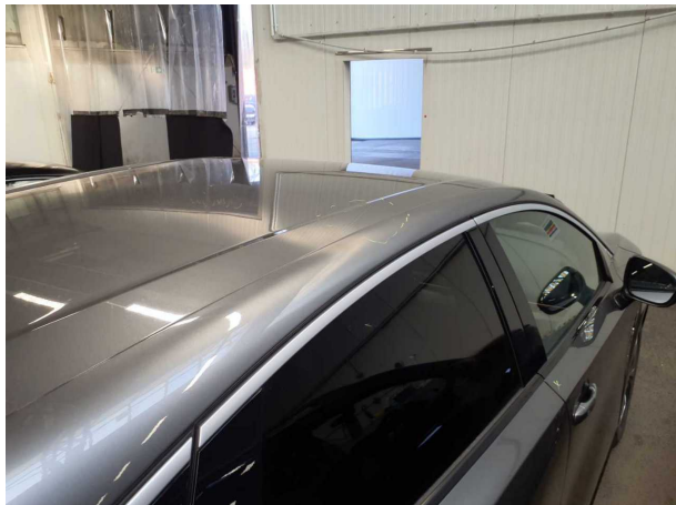
Beschädigung #1: Fahrzeugdach: Dachholm rechts - verkratzt / verschürft - Smart Repair
