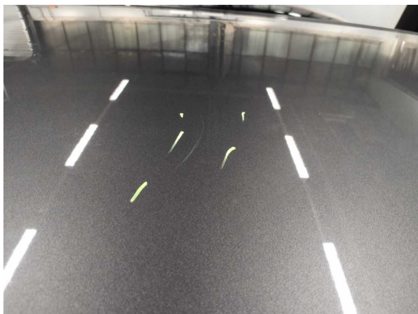
Beschädigung #2: Fahrzeugdach: Dach - verkratzt / verschürft - lackieren
