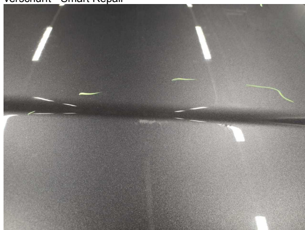
Beschädigung #2: Fahrzeugdach: Dach - verkratzt / verschürft - lackieren
