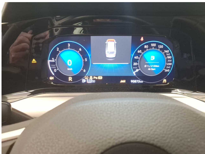
Damage 1: Instrument panel: Indicator light (Mehrere Leuchten im Zusammenhang mit niedr. Bordnetzspannung) - Specify findings - Perform diagnosis
