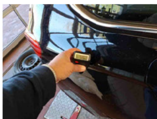
Lackstärke Seitenwand hinten rechts
