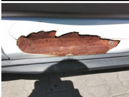
Tür / Hinten Rechts / Schlecht Repariert
