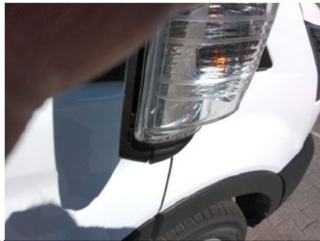
Blinker / Vorne Rechts / Gebrochen
