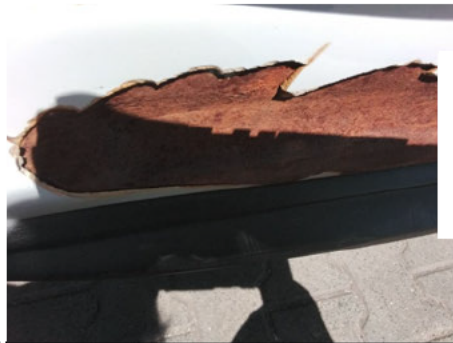
Tür / Hinten Rechts / Schlecht Repariert
