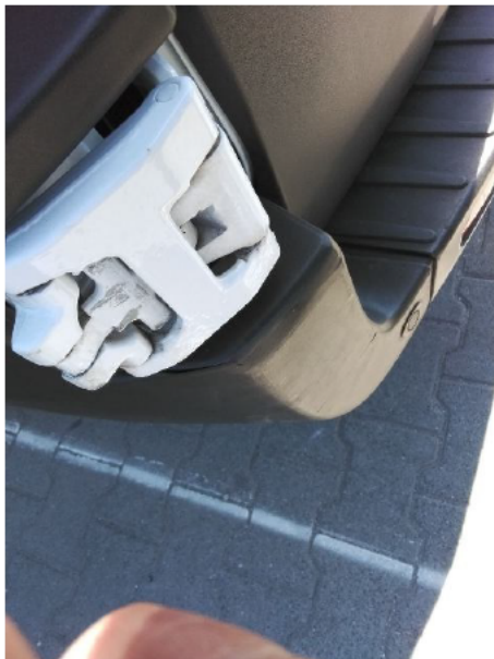
Stoßfänger / Hinten Links / Gebrochen
