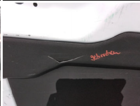
Innenverkleidung Laderaum / Hinten Links / Gebrochen
