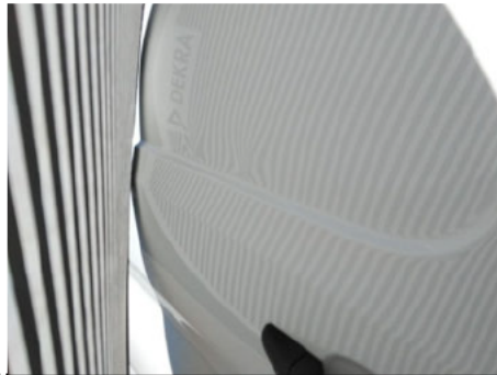
Tür / Hinten Rechts / Schlecht Repariert
