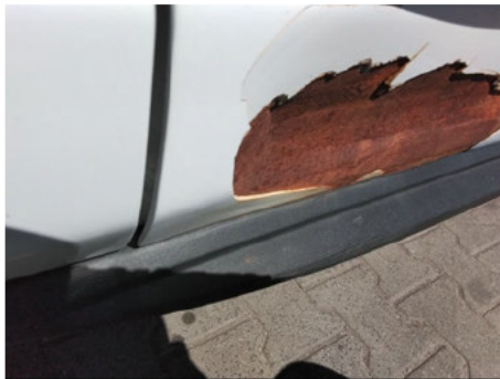
Tür / Hinten Rechts / Schlecht Repariert
