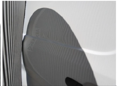
Tür / Hinten Rechts / Schlecht Repariert
