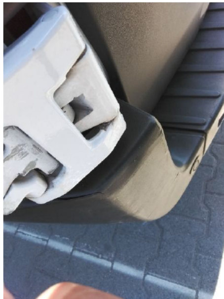
Stoßfänger / Hinten Links / Gebrochen
