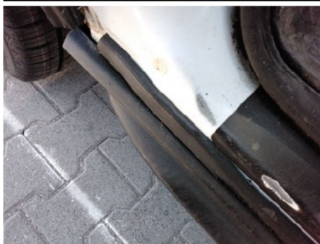
Türeinstieg / Vorne Links / Kratzer
