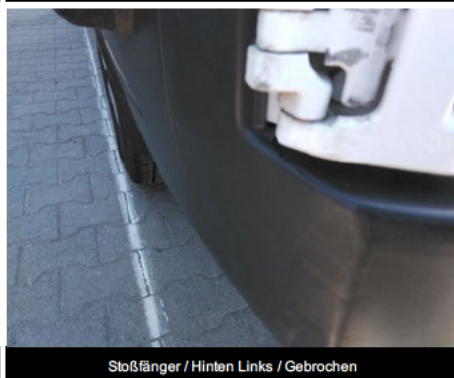
Stoßfänger / Hinten Links / Gebrochen
