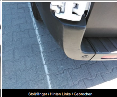
Stoßfänger / Hinten Links / Gebrochen
