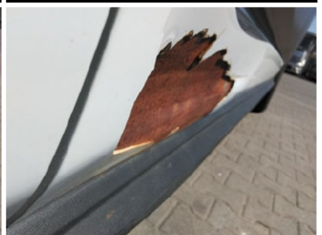
Tür / Hinten Rechts / Schlecht Repariert
