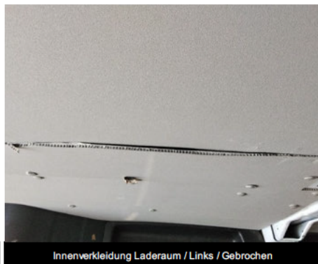
Innenverkleidung Laderaum / Links / Gebrochen
