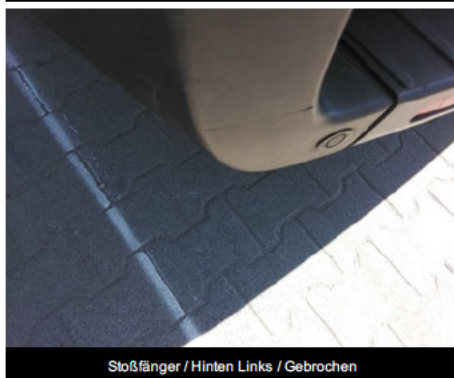
Stoßfänger / Hinten Links / Gebrochen
