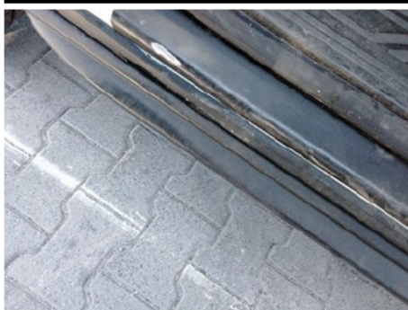
Zierfolie Türrahmen / Vorne Links / Gebrochen
