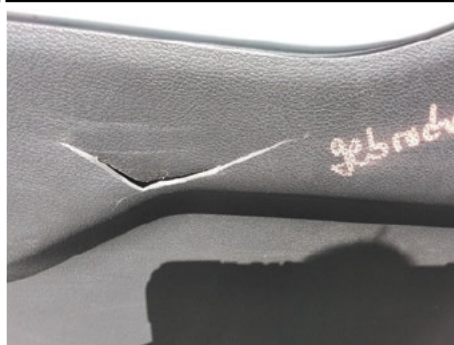
Innenverkleidung Laderaum / Hinten Links / Gebrochen
