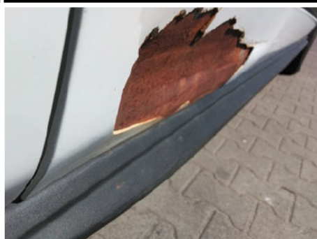
Tür / Hinten Rechts / Schlecht Repariert
