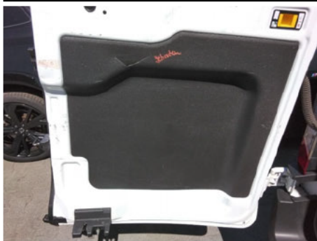
Innenverkleidung Laderaum / Hinten Links / Gebrochen
