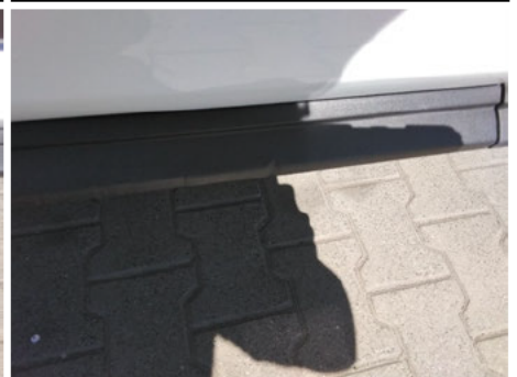
Schwellerverkleidung / Hinten Rechts / Kratzer
