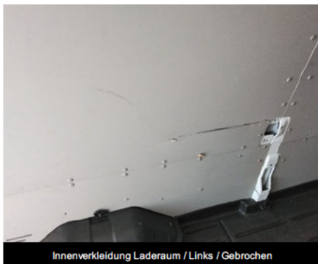
Innenverkleidung Laderaum / Links / Gebrochen
