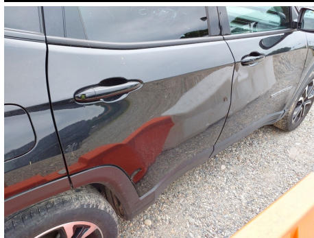
Porta / Posteriore Destro / Ammaccato vernice incisa
