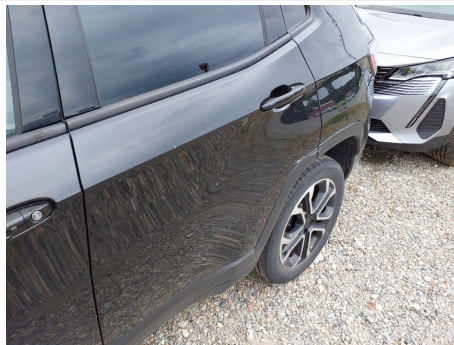
Porta / Posteriore Sinistro / Ammaccato vernice incisa
