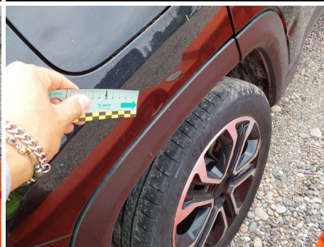
Parafango / Posteriore Destro / Ammaccato vernice incisa
