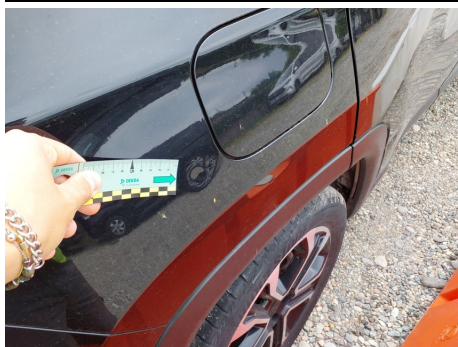
Parafango / Posteriore Destro / Ammaccato vernice incisa
