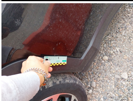
Porta / Posteriore Destro / Ammaccato vernice incisa
