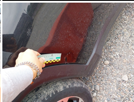
Porta / Posteriore Destro / Ammaccato vernice incisa
