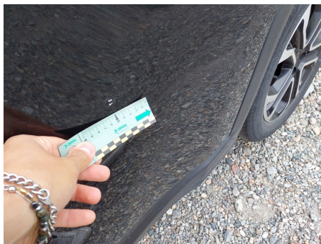
Porta / Posteriore Sinistro / Ammaccato vernice incisa
