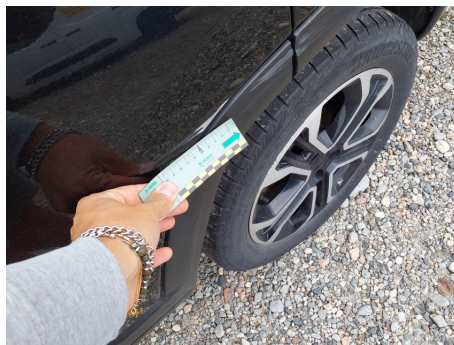
Porta / Posteriore Sinistro / Ammaccato vernice incisa
