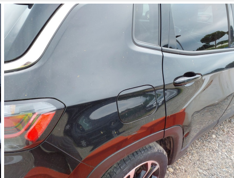
Parafango / Posteriore Destro / Ammaccato vernice incisa
