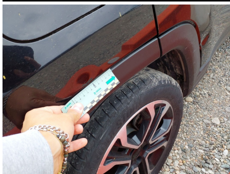
Parafango / Posteriore Destro / Ammaccato vernice incisa
