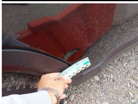
Porta / Posteriore Destro / Ammaccato vernice incisa
