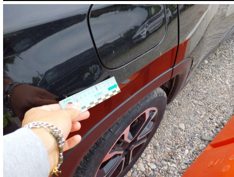
Parafango / Posteriore Destro / Ammaccato vernice incisa
