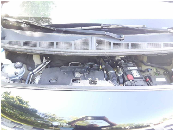
Beschädigung #2: Motor: Motorabdeckung - Marderschaden - erneuern
