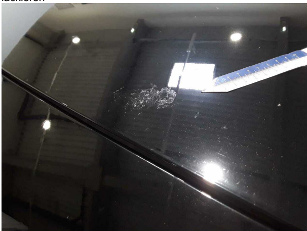
Beschädigung #6: Motorhaube: Motorhaube (Vogelkot) - Lackmangel - lackieren
