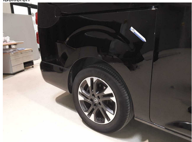
Beschädigung #8: Seitenwand rechts: Seitenwand - Kratzer - lackieren
