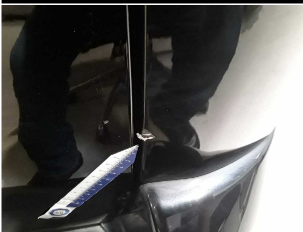
Beschädigung #3: Heckbereich: Heckbereich (Blende rechts) - verkratzt / verschürft - erneuern
