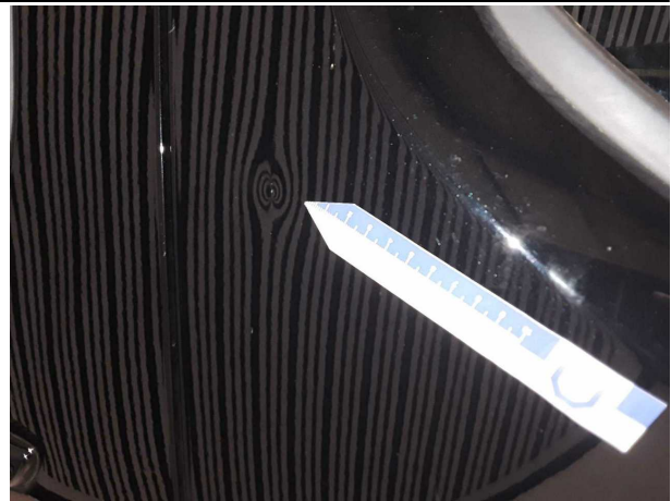
Beschädigung #10: Tür vorn rechts: Tür - Delle / Lackschaden - instandsetzen und lackieren
