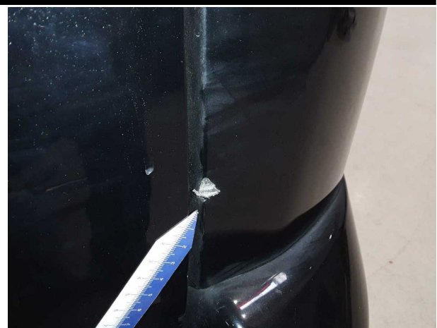
Beschädigung #3: Heckbereich: Heckbereich (Blende rechts... verkratzt / verschürft - erneuern
