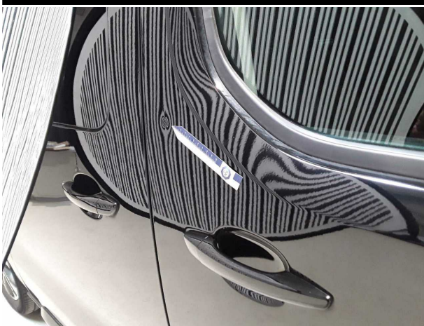
Beschädigung #10: Tür vorn rechts: Tür - Delle / Lackschaden - instandsetzen und lackieren
