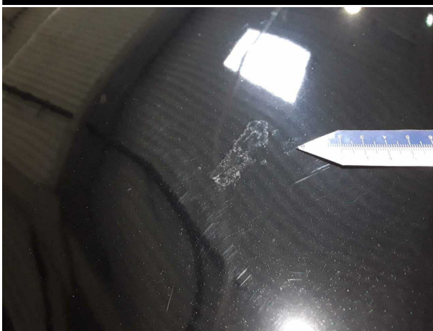
Beschädigung #6: Motorhaube: Motorhaube (Vogelkot) - Lackmangel - lackieren
