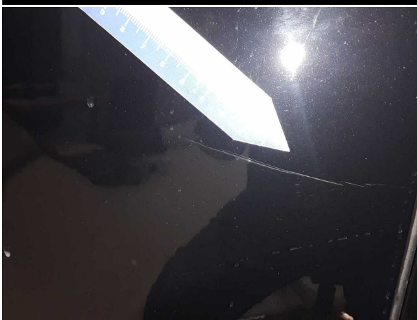
Beschädigung #8: Seitenwand rechts: Seitenwand - Kratzer - lackieren
