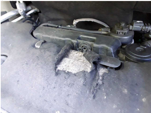
Beschädigung #2: Motor: Motorabdeckung - Marderschaden - erneuern
