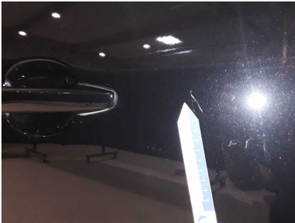
Beschädigung #9: Tür hinten links: Tür - Kratzer - lackieren
