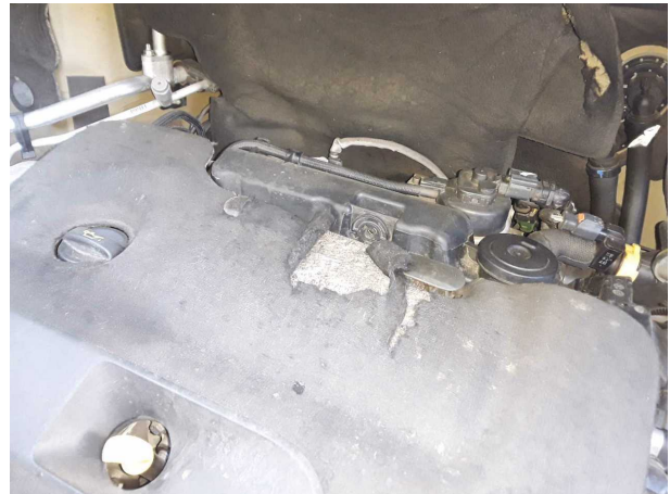
Beschädigung #2: Motor: Motorabdeckung - Marderschaden - erneuern
