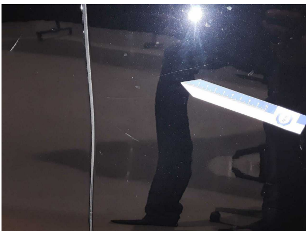
Beschädigung #9: Tür hinten links: Tür - Kratzer - lackieren
