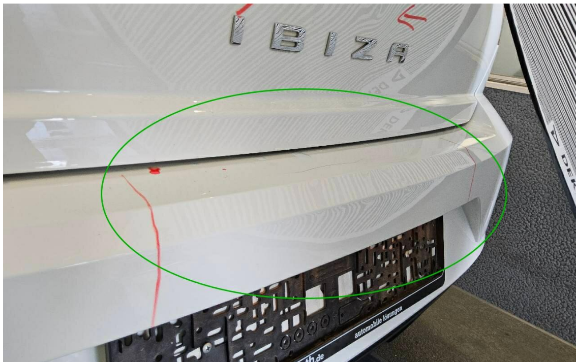
Bild 21 : Stoßfänger hinten, verformt
