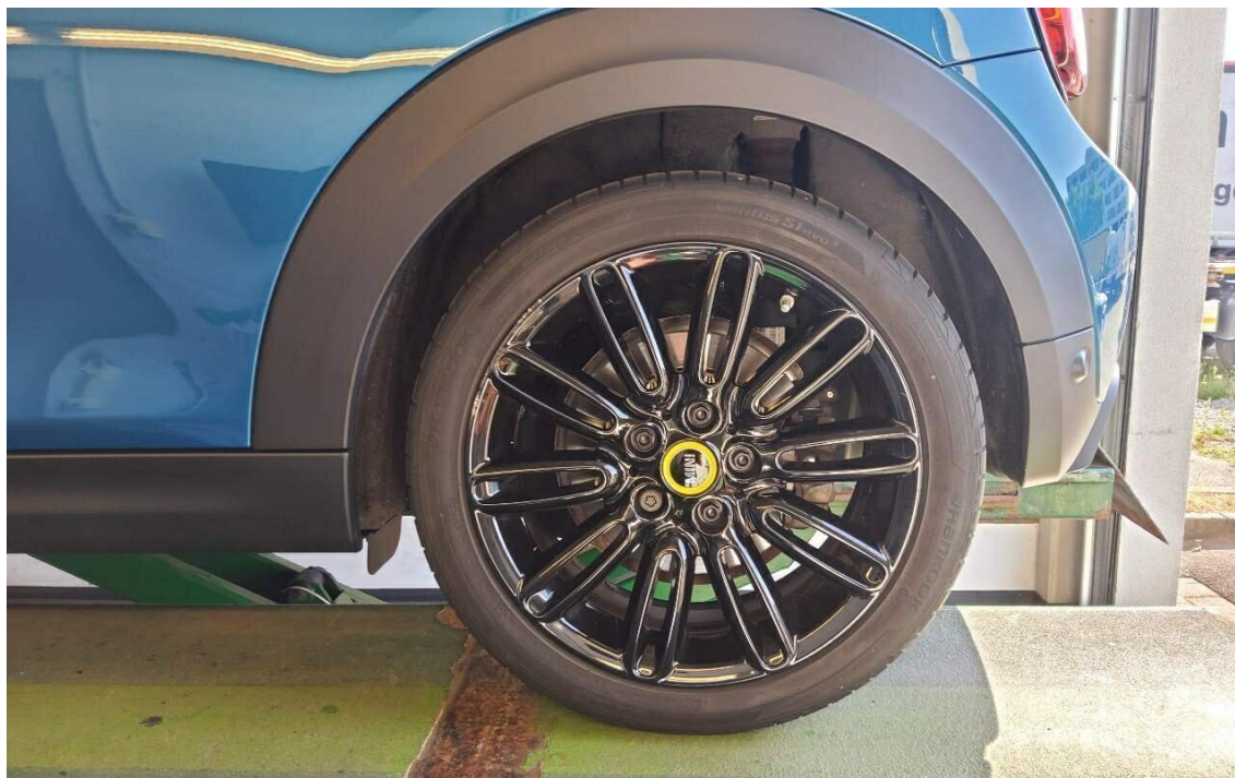
Bild 15 : Felge hinten links Lackierung, verschrammt, smart repair
