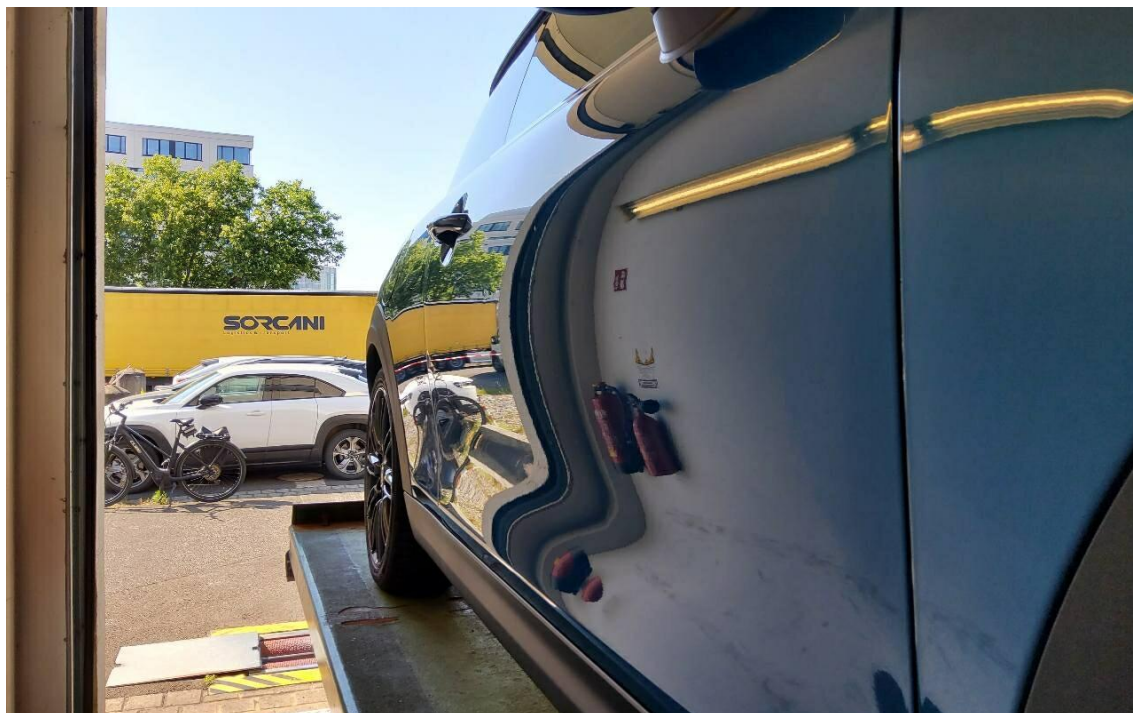
Bild 19 : Tür vorne rechts, eingedellt, drücken
