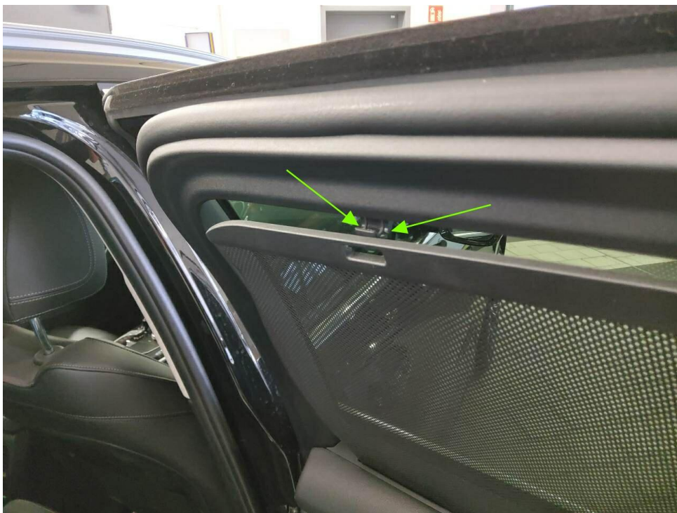
Bild 18 : Halter Sonnenschutz Tür hinten rechts zerbrochen
