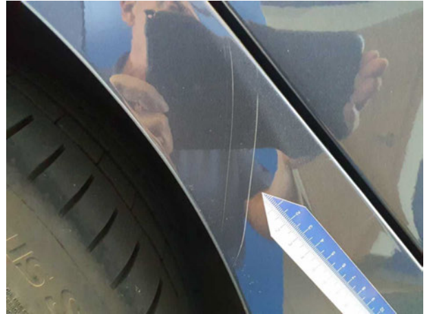
Beschädigung #1: Seitenwand rechts: Seitenwand - Kratzer - Smart Repair
