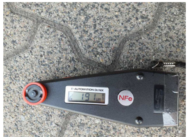
Nachlackierung 1: Motorhaube, Tür vorne links
