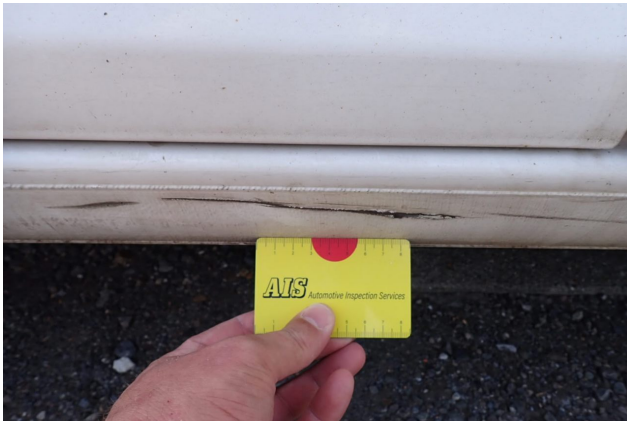
Beschädigung 4: Schweller rechts: Schweller - beschädigt - instandsetzen und lackieren
