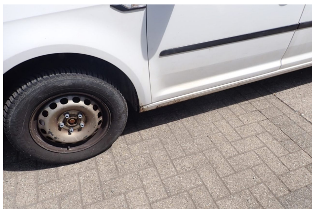
Beschädigung 3: Schweller links: Schweller - Korrosion - instandsetzen und lackieren
