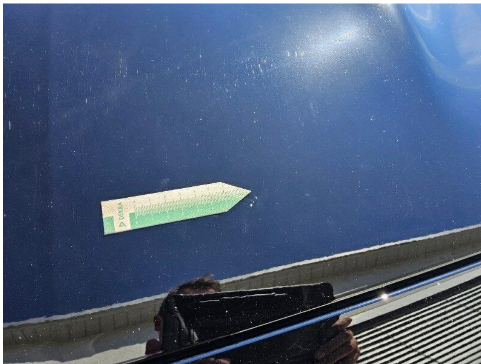
Bild 16 : Motorhaube Lackierung, Steinschlag, Gebrauchsspur
