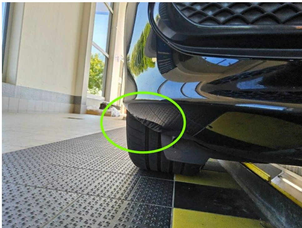
Bild 18 : Frontspoiler, verschrammt, Gebrauchsspur
