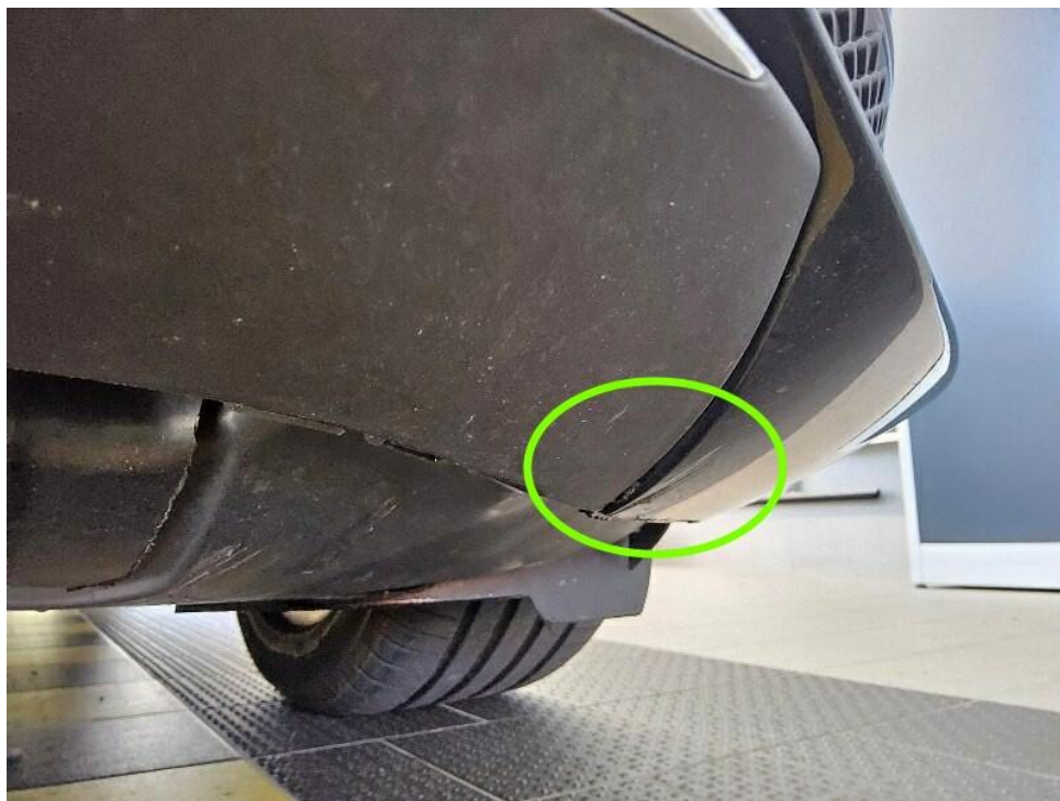
Bild 19 : Frontspoiler, verschrammt, Gebrauchsspur
