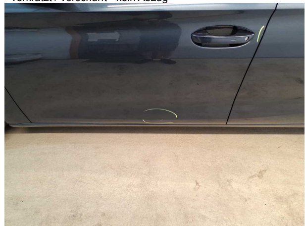
Beschädigung #5: Tür vorn links: Tür - verkratzt / verschürft - instandsetzen und lackieren
