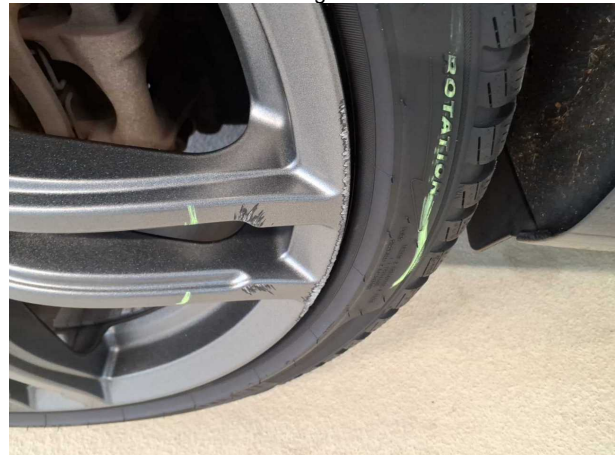
Beschädigung #2: Rad/Reifen: Leichtmetallfelge hinten rechts - verkratzt / verschürft - kein Abzug
