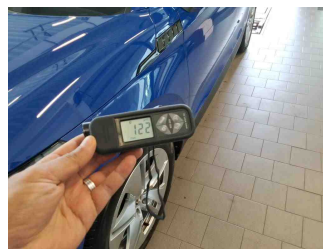
Lackstärke Kotflügel vorne links
