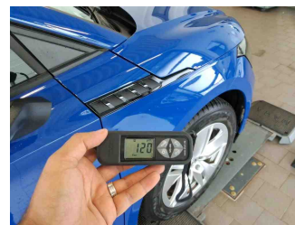
Lackstärke Kotflügel vorne rechts
