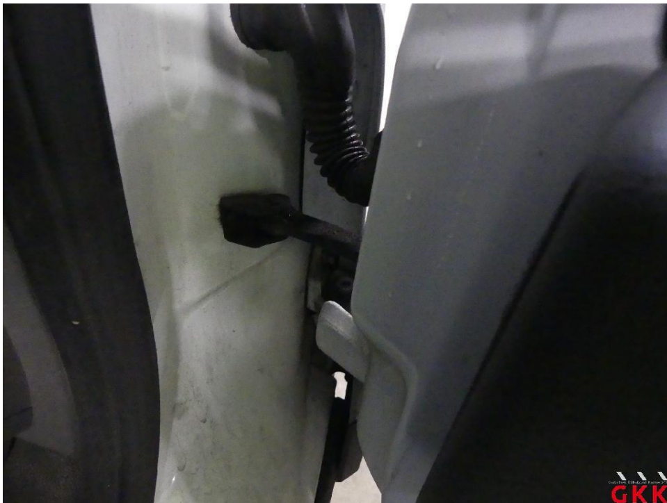
Bild 16 Tür vorne rechts, Fangband / Feststeller, untypische Geräusche, ersetzen
