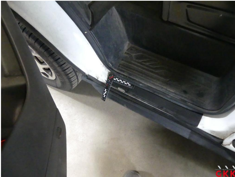
Bild 23 Tür vorne links, Einstieg, verkratzt, Smartrepair
