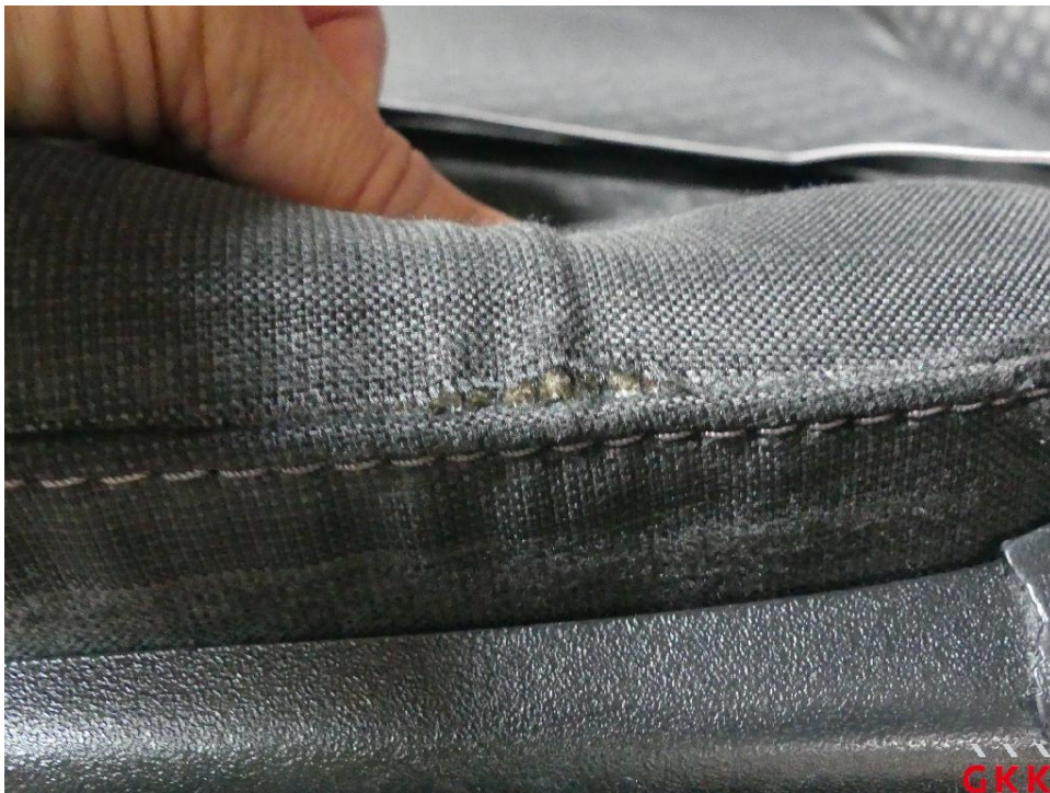
Bild 26 Sitz vorne links, Bezug Sitzkissen -Stoff-, gerissen, ersetzen
