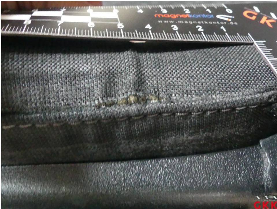
Bild 27 Sitz vorne links, Bezug Sitzkissen -Stoff-, gerissen, ersetzen
