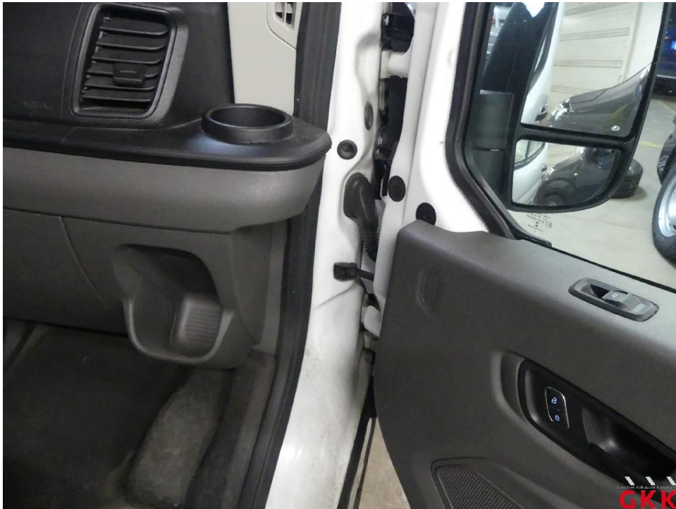
Bild 15 Tür vorne rechts, Fangband / Feststeller, untypische Geräusche, ersetzen
