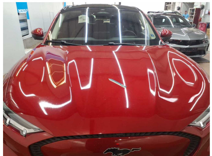
Damage 7: Bonnet: Bonnet (Verätzungen / mit Kratzer) - Paint defect - Paint
