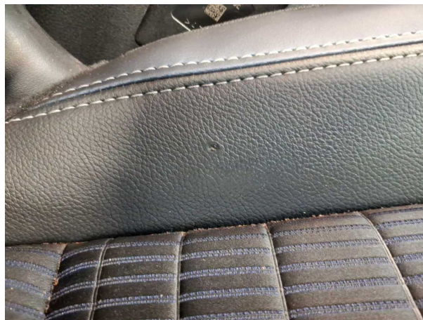
Beschädigung #1: Sitz vorn: Sitzbezug rechts - Brandloch - Smart Repair
