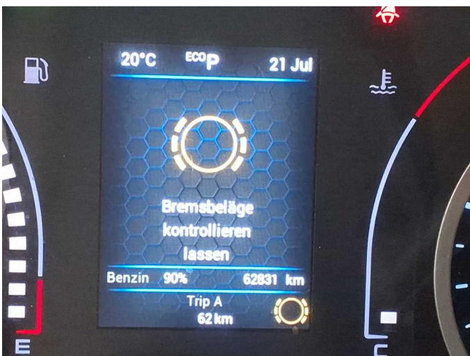
Damage 3: Braking system: Braking system (Bremsbelag Verschleißsensor aktiv, Mehrkosten wahrscheinlich) - Specify findings - Perform diagnosis
