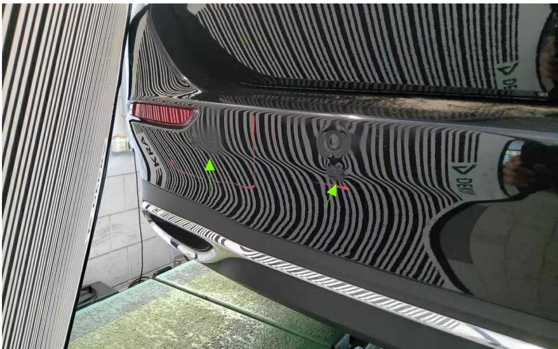
Bild 18 : Stoßfänger hinten mehrfach angefahren
