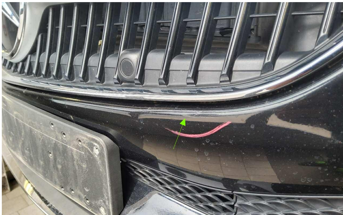
Bild 23 : Stoßfänger vorne verschrammt
