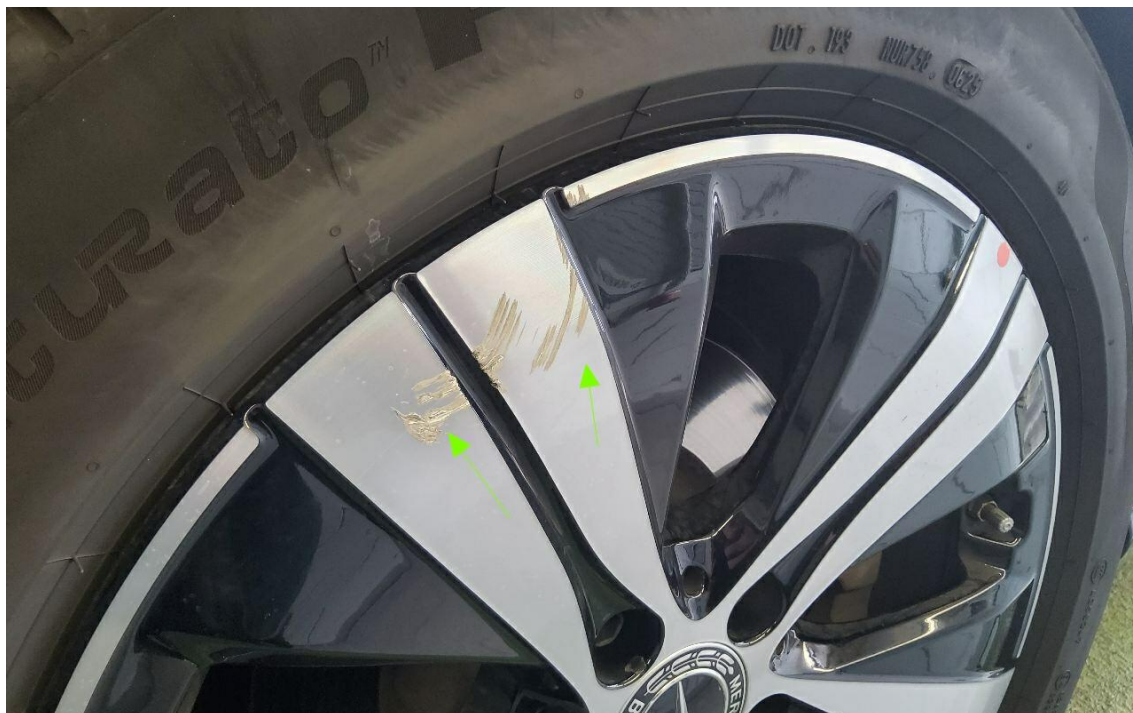
Bild 19 : Alufelge (Sommer glanzgedreht) hinten rechts verschrammt
