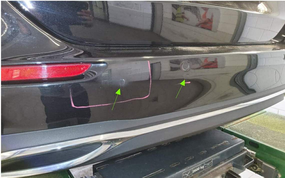
Bild 17 : Stoßfänger hinten mehrfach angefahren
