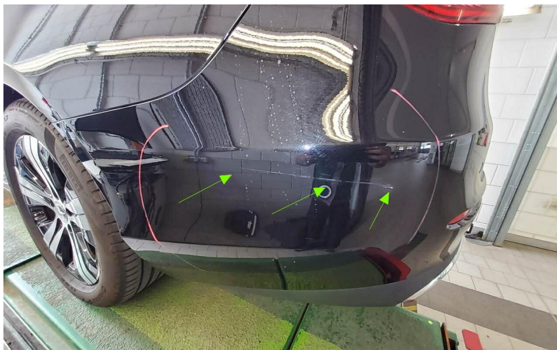
Bild 16 : Stoßfänger hinten mehrfach angefahren
