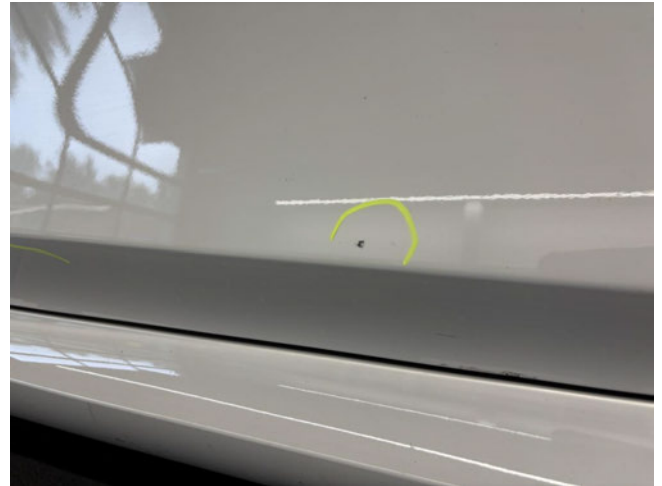
Tür vorne rechts - zerkratzt - Lackieren
