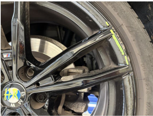
Felge (Sommer-Radsatz) - Hinterachse rechts - Kratzer - lackieren
