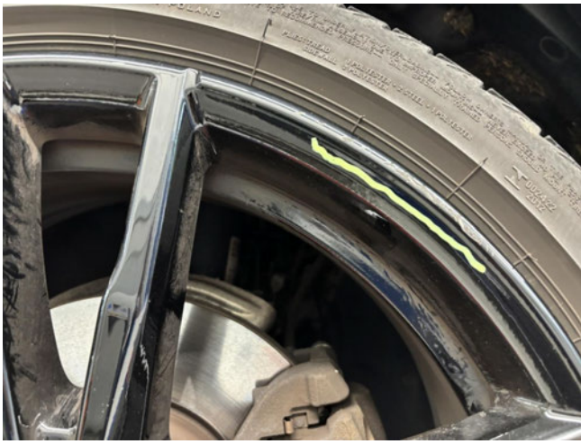
Felge (Sommer-Radsatz) - Vorderachse links - Kratzer - lackieren
