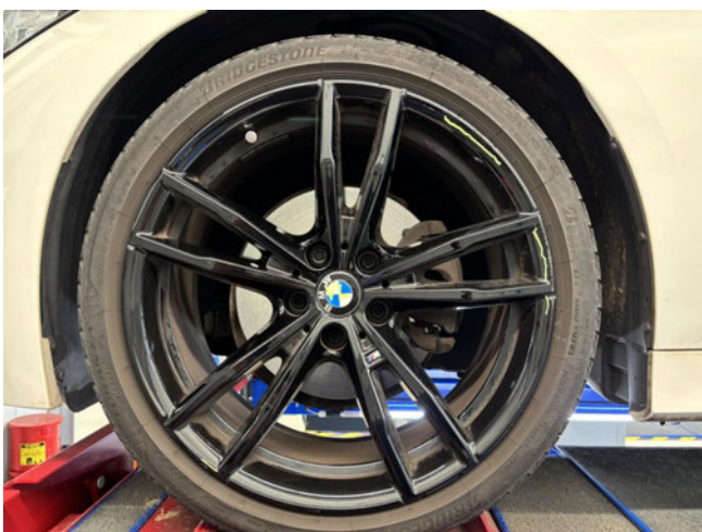
Felge (Sommer-Radsatz) - Vorderachse links - Kratzer - lackieren
