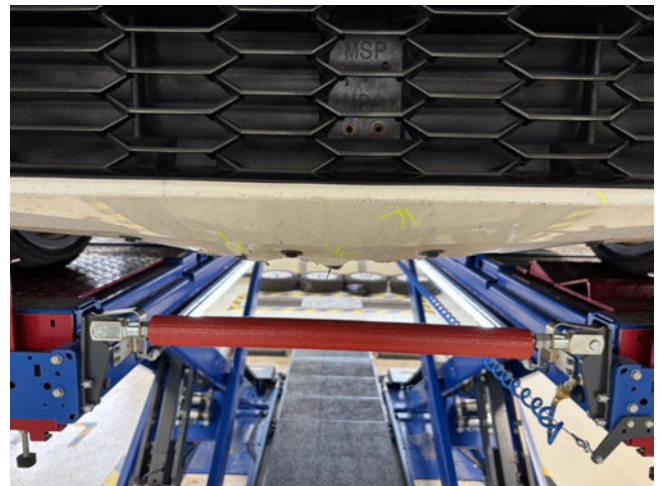
Stoßfänger vorne - stark deformiert - erneuern
