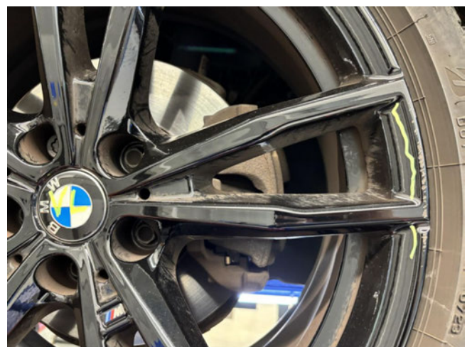
Felge (Sommer-Radsatz) - Vorderachse links - Kratzer - lackieren
