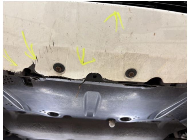
Stoßfänger vorne - stark deformiert - erneuern
