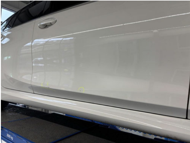
Tür vorne rechts - zerkratzt - Lackieren
