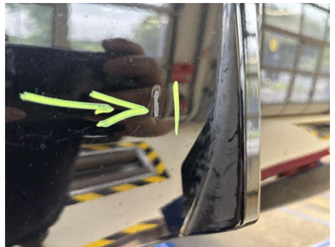
Stoßfänger hinten - zerkratzt - smart Repair
