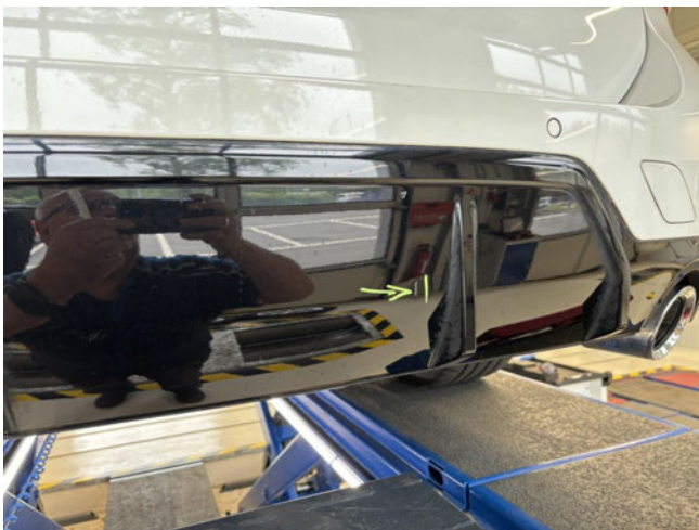
Stoßfänger hinten - zerkratzt - smart Repair
