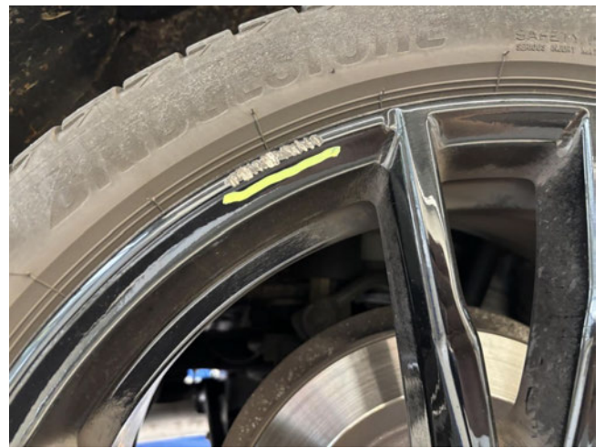
Felge (Sommer-Radsatz) - Hinterachse rechts - Kratzer - lackieren
