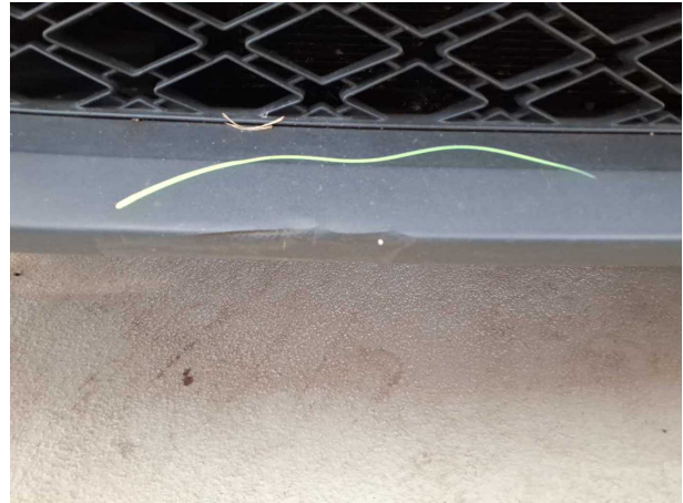
Beschädigung #2: Stossfänger vorn: Spoiler - verkratzt / verschürft - Wertminderung
