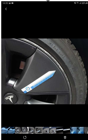
Beschädigung #3: Rad/Reifen: Leichtmetallfelge vorn links - Kratzer - Wertminderung
