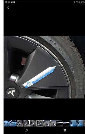
Beschädigung #2: Rad/Reifen: Leichtmetallfelge hinten rechts - Kratzer - Wertminderung
