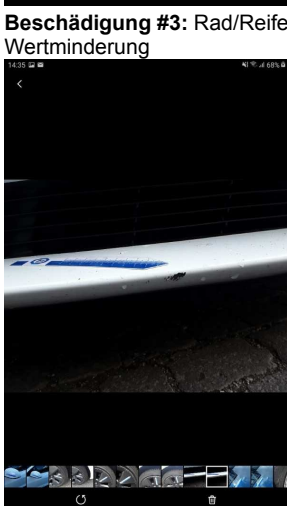
Beschädigung #5: Stossfänger vorn: Stossfänger vorn - verkratzt / verschürft - Smart Repair
