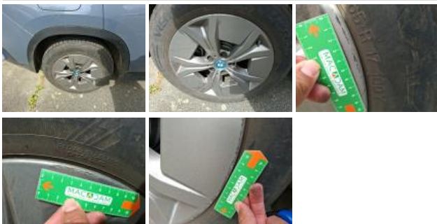
Alloy rim RL, Scratch(es), Repair/replace (lump sum)
