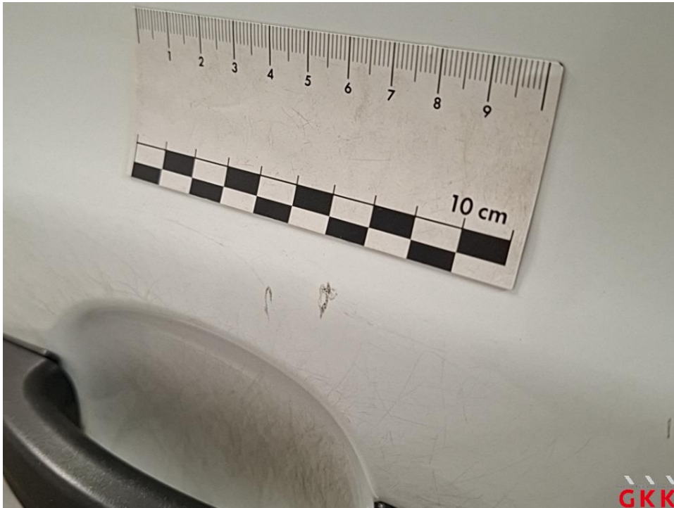
Bild 23 Tür vorne links, verkratzt, lackieren
