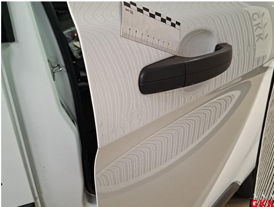
Bild 40 Tür vorne rechts, beschädigt, instand setzen - lackieren
