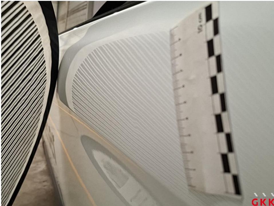
Bild 27 Seitenwand links, beschädigt, kalt drücken
