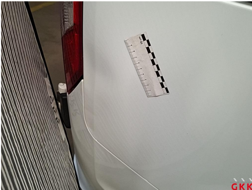
Bild 30 Seitenwand rechts, beschädigt, instand setzen - lackieren
