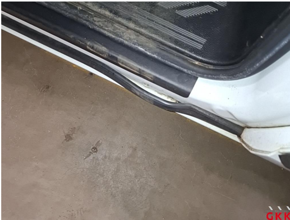
Bild 24 Tür vorne links, Dichtung -Einstieg-, beschädigt, ersetzen
