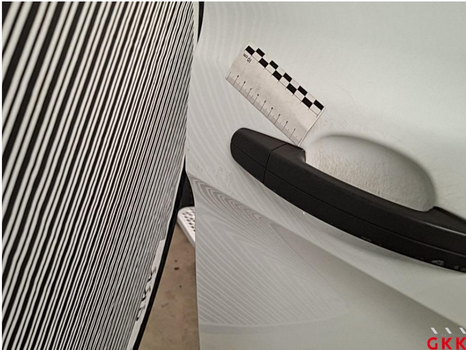
Bild 39 Tür vorne rechts, beschädigt, instand setzen - lackieren
