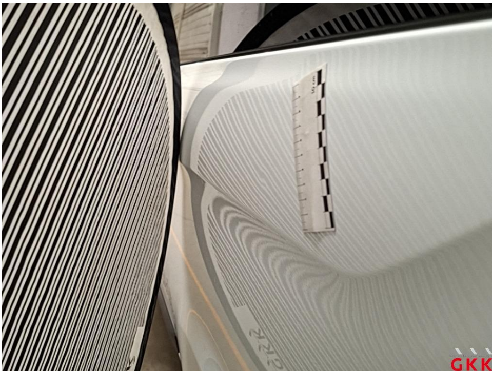
Bild 26 Seitenwand links, beschädigt, kalt drücken
