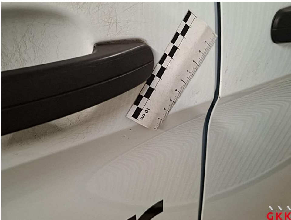
Bild 38 Schiebetür rechts, beschädigt, instand setzen - lackieren
