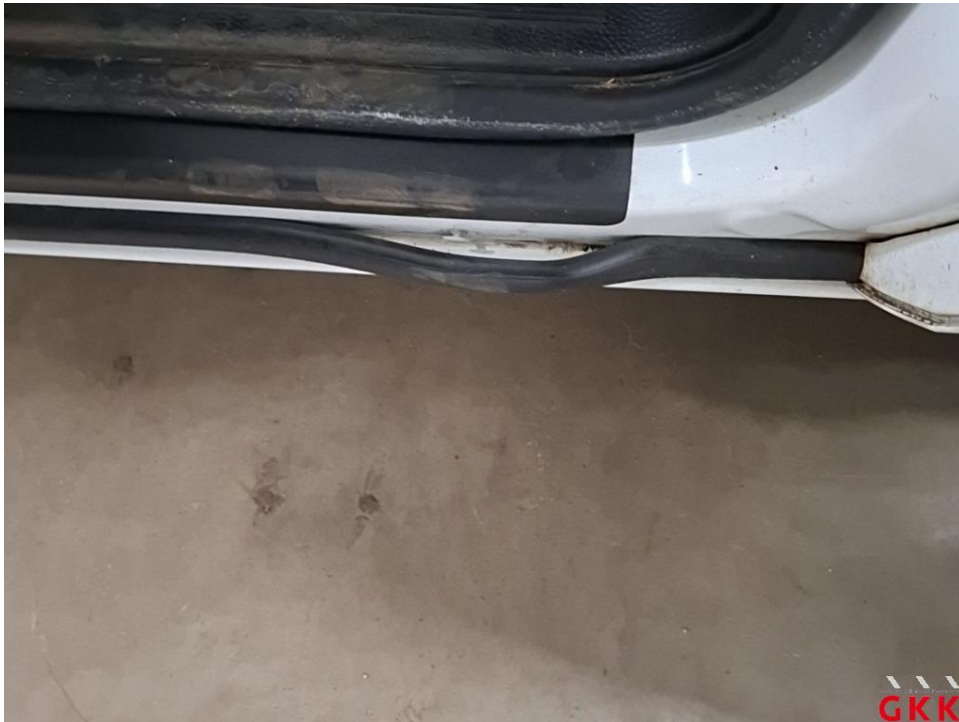
Bild 25 Tür vorne links, Dichtung -Einstieg-, beschädigt, ersetzen
