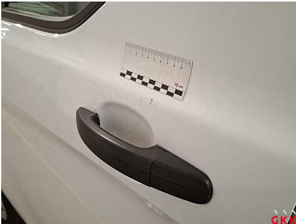
Bild 22 Tür vorne links, verkratzt, lackieren
