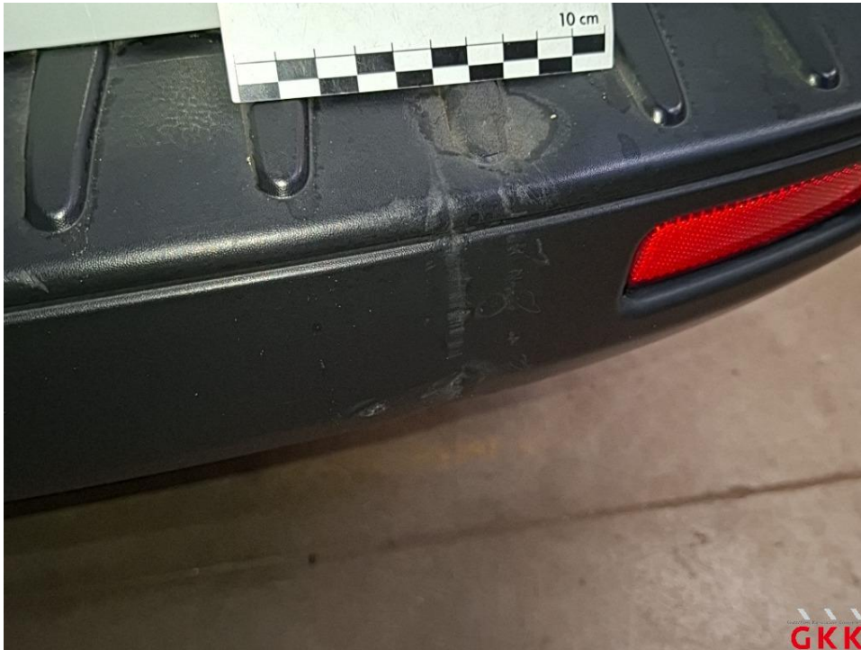
Bild 29 Stoßfänger hinten, Verkleidung -unlackiert-, beschädigt, ersetzen
