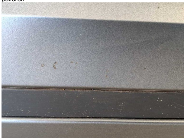
Beschädigung #3: Stossfänger hinten: Spoiler - verkratzt / verschürft - Wertminderung
