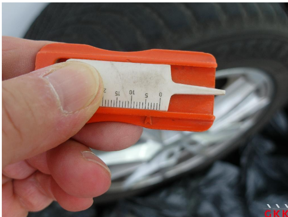
Bild 24. Reifen, 2 x beiliegend, Untermaß, ersetzen
