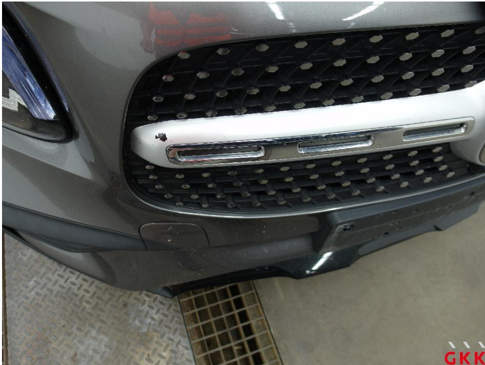
Bild 14. Frontgrill - Leiste, verkratzt, lackieren
