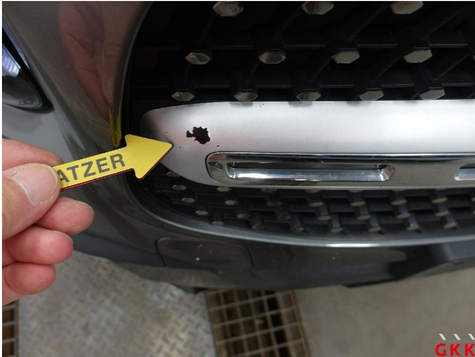
Bild 15. Frontgrill - Leiste, verkratzt, lackieren
