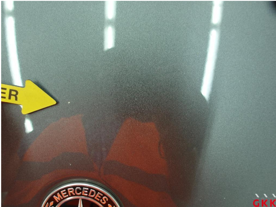
Bild 18. Motorhaube, Steinschlag, auslegen, schleifen, polieren
