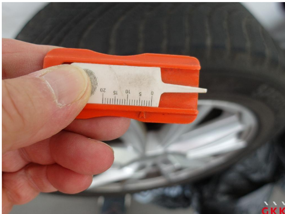
Bild 23. Reifen, 2 x beiliegend, Untermaß, ersetzen
