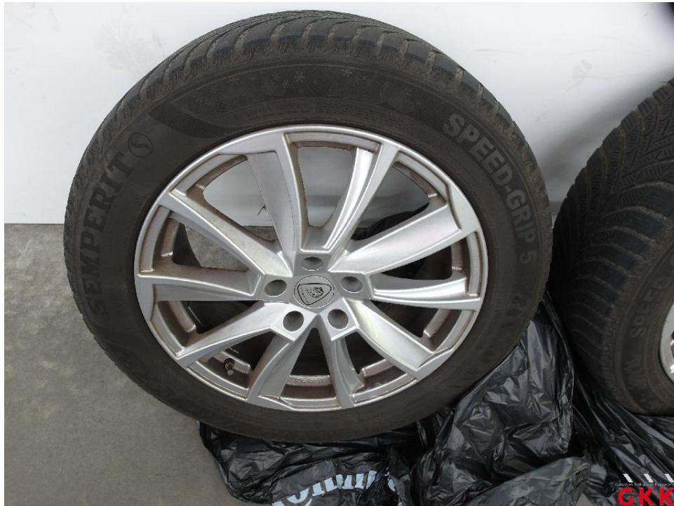
Bild 22. Reifen, 2 x beiliegend, Untermaß, ersetzen
