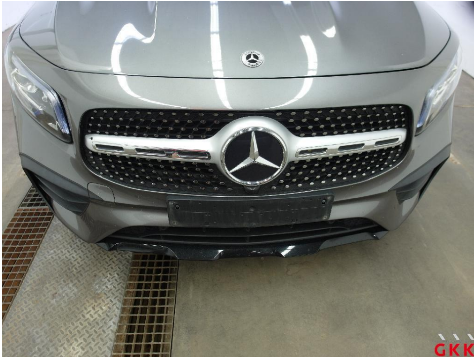
Bild 13. Frontgrill - Leiste, verkratzt, lackieren
