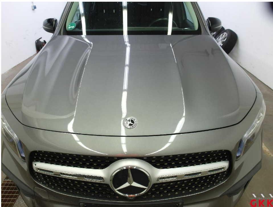
Bild 16. Motorhaube, Steinschlag, auslegen, schleifen, polieren
