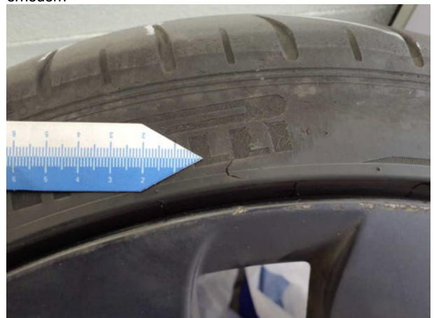
Beschädigung #11: 2.Radsatz: 1 Reifen (Sommer) - beschädigt - erneuern
