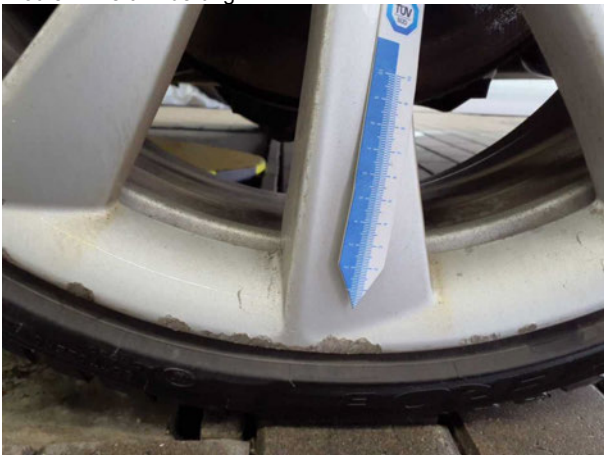
Beschädigung #5: Rad/Reifen: Leichtmetallfelge hinten links (Winter) - Kratzer - Wertminderung
