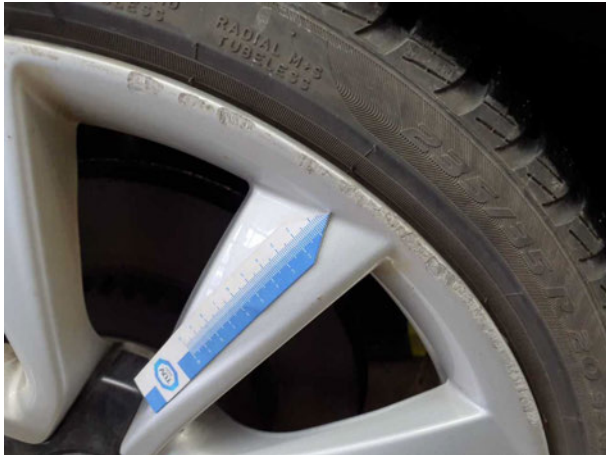
Beschädigung #7: Rad/Reifen: Leichtmetallfelge vorn rechts (Winter) - Kratzer - Wertminderung
