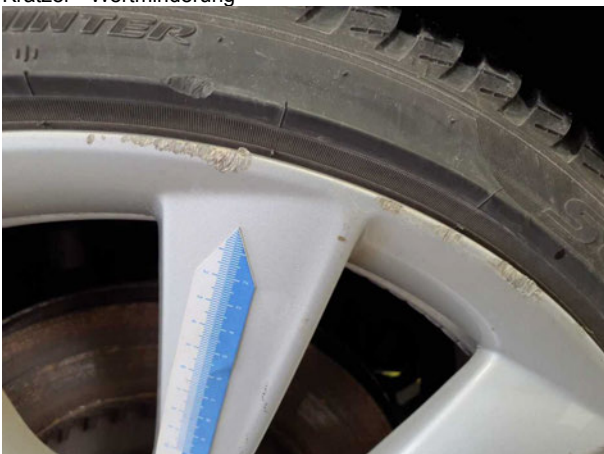
Beschädigung #6: Rad/Reifen: Leichtmetallfelge hinten rechts (Winter) - Kratzer - Wertminderung
