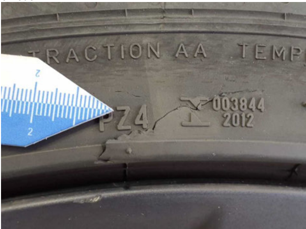
Beschädigung #12: 2.Radsatz: 1 Reifen (Sommer) - beschädigt - erneuern
