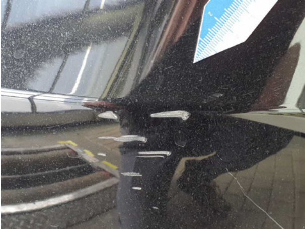
Beschädigung #14: Stossfänger hinten: Stossfänger hinten - Kratzer - lackieren
