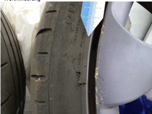
Beschädigung #11: 2.Radsatz: 1 Reifen (Sommer) - beschädigt - erneuern
