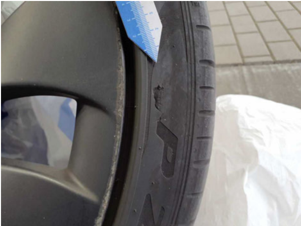
Beschädigung #11: 2.Radsatz: 1 Reifen (Sommer) - beschädigt - erneuern
