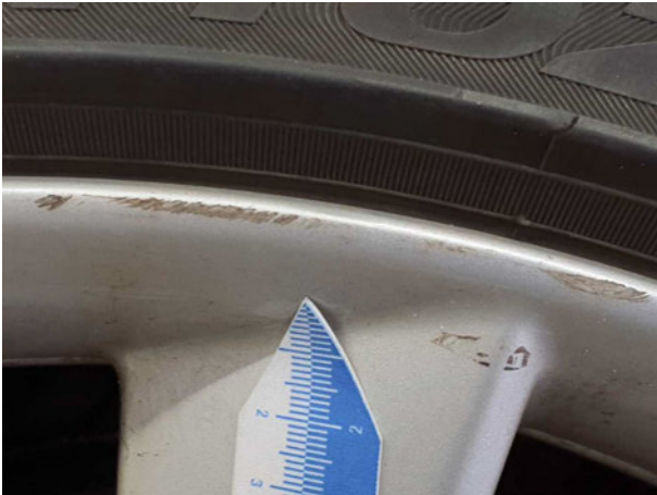
Beschädigung #4: Rad/Reifen: Leichtmetallfelge vorn links (Winter) - Kratzer - Wertminderung
