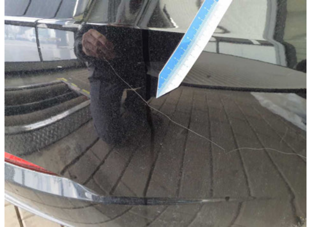
Beschädigung #14: Stossfänger hinten: Stossfänger hinten - Kratzer - lackieren
