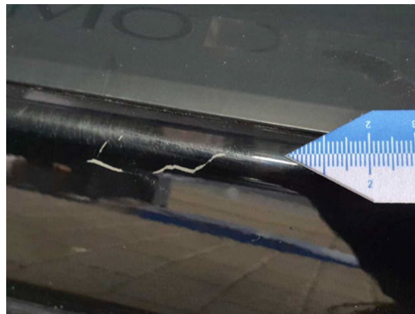
Beschädigung #1: Schweller links: Einstieg - Kratzer - Smart Repair
