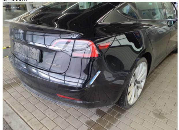
Beschädigung #14: Stossfänger hinten: Stossfänger hinten - Kratzer - lackieren
