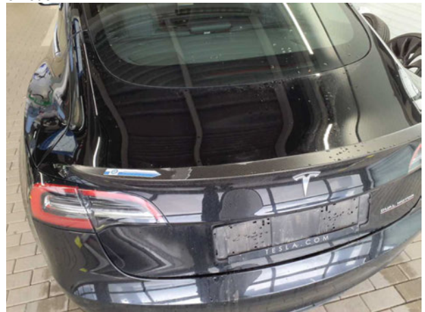
Beschädigung #13: Heckklappe/-tür: Heckspoiler - Lackmangel - erneuern
