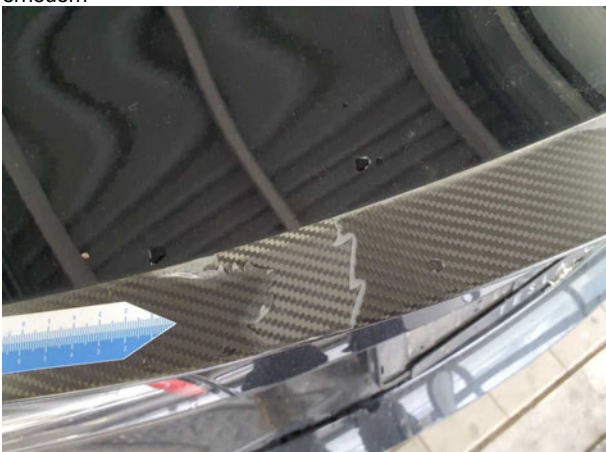
Beschädigung #13: Heckklappe/-tür: Heckspoiler - Lackmangel - erneuern
