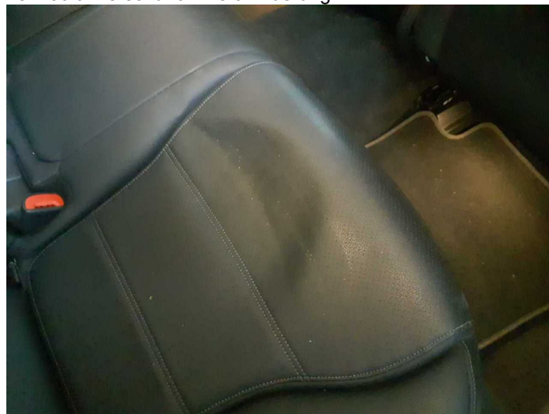
Beschädigung #4: Sitz hinten: Rücksitz (2ter Radsatz lag auf der Rücksitzbank) - verformt - Smart Repair
