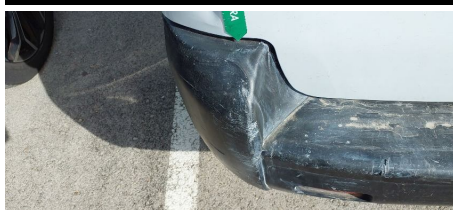
Paragolpes / Trasero Izquierdo / Abolladura
