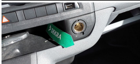
Tapa toma de corriente de 12V / Delantero / Roto
