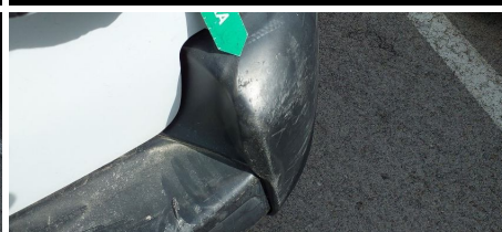
Paragolpes / Trasero Derecho / Abolladura
