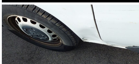
Aleta / Trasero Derecho / Abolladura
