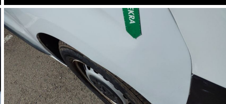
Aleta / Delantero Derecho / Abolladura
