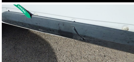
Moldura de puerta / Trasero Derecho / Roto
