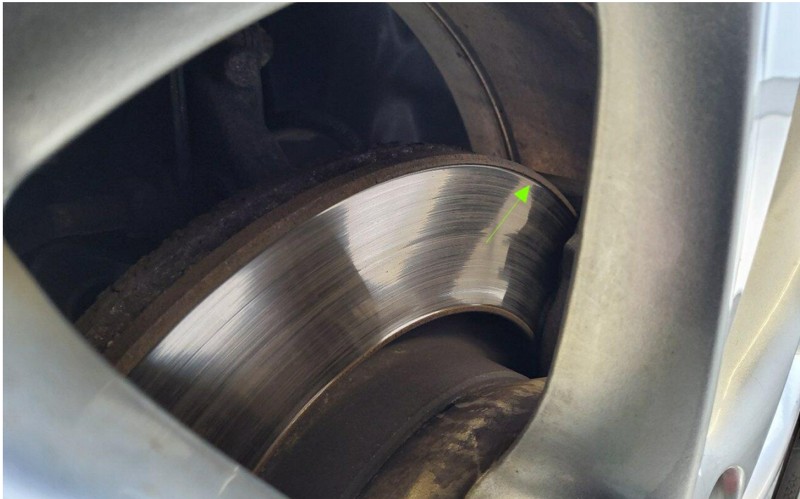
Bild 17 : T- Bremsscheiben Vorderachse eingelaufen
