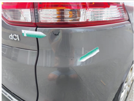
Stoßfänger / Hinten Rechts / Delle
