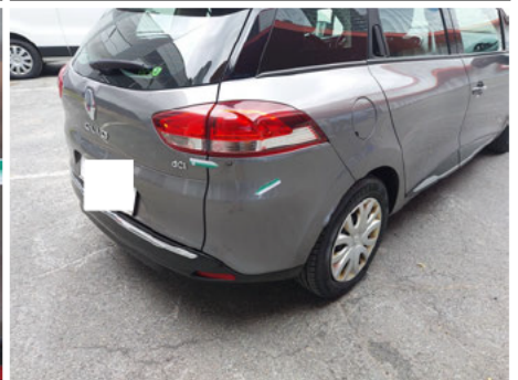
Stoßfänger / Hinten Rechts / Delle
