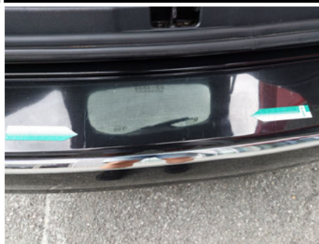
Stoßfänger / Hinten / Abgewetzt
