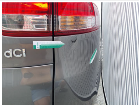
Stoßfänger / Hinten Rechts / Delle
