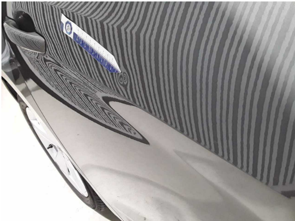
Beschädigung #2: Tür hinten rechts: Tür - Delle(n) - Smart Repair
