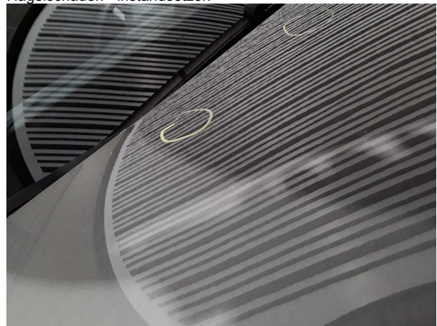
Beschädigung #4: Karosserie: Karosserie (10 Dellen) - Hagelschaden - instandsetzen
