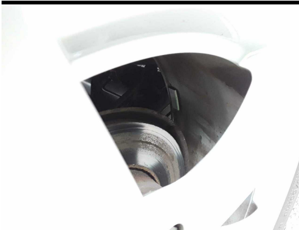
Beschädigung #3: Bremsanlage: Bremsscheiben hinten - verschlissen - erneuern
