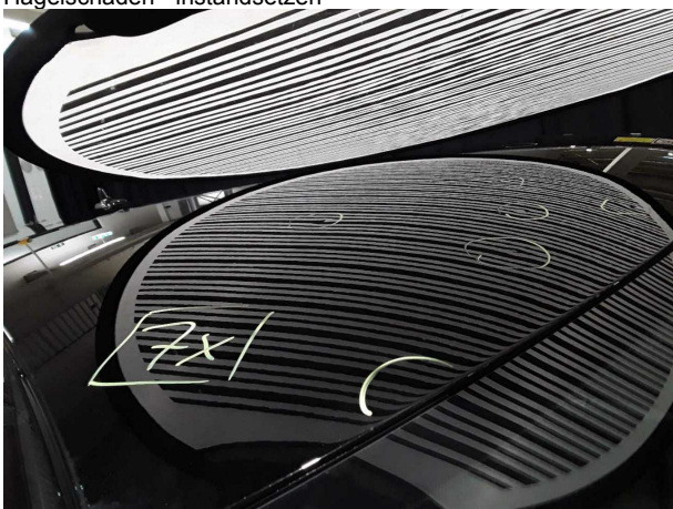
Beschädigung #4: Karosserie: Karosserie (10 Dellen) - Hagelschaden - instandsetzen
