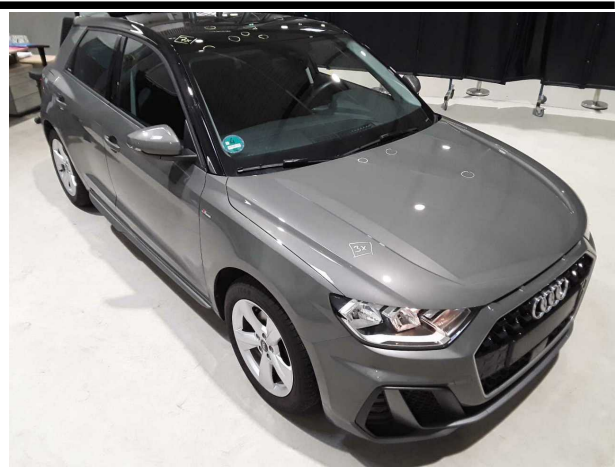
Beschädigung #4: Karosserie: Karosserie (10 Dellen) - Hagelschaden - instandsetzen
