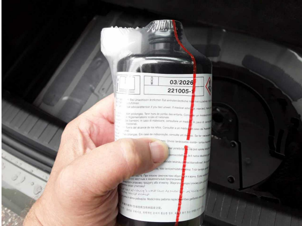
Beschädigung #1: Ausrüstung: Tirefit Füllmittel - abgelaufen - erneuern
