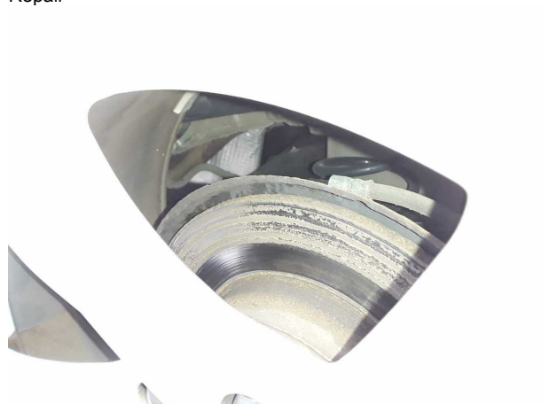
Beschädigung #3: Bremsanlage: Bremscheiben hinten - verschlissen - erneuern
