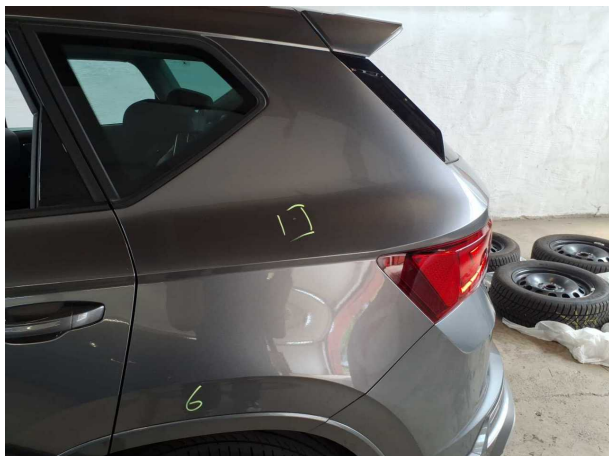
Beschädigung #1: Seitenwand links: Seitenwand - Kratzer - auslegen / polieren
