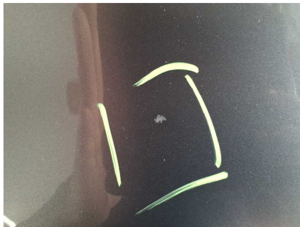
Beschädigung #1: Seitenwand links: Seitenwand - Kratzer - auslegen / polieren
