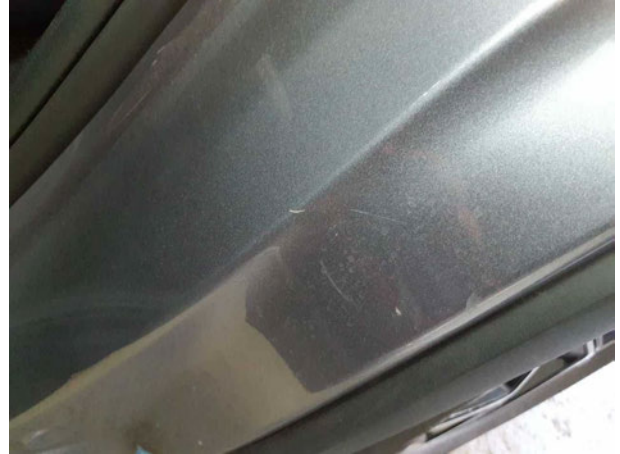
Beschädigung #1: Seitenwand links: Einstieg - Kratzer - Smart Repair
