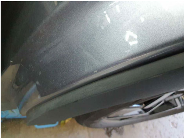
Beschädigung #1: Seitenwand links: Einstieg - Kratzer - Smart Repair
