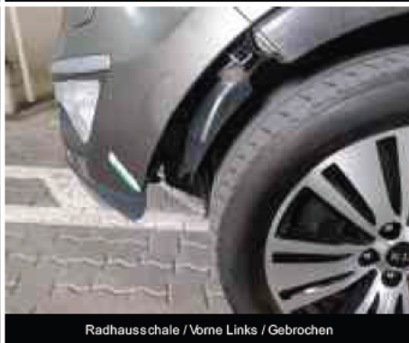
Radhausschale / Vorne Links / Gebrochen
