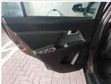
Türverkleidung / Hinten Links / Abgewetzt
