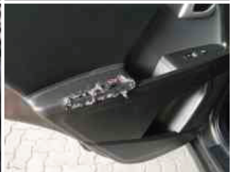
Türverkleidung / Hinten Links / Abgewetzt
